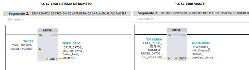
Figura 3.33: Traslado de datos entre PLCs.
