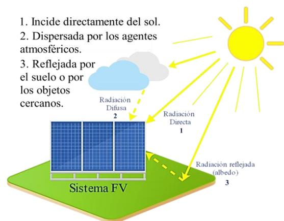
Figura 4. Componentes de radiación solar
