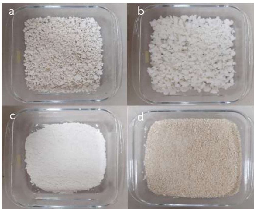
Figura 16. Celulosa con diferente tipo de agua y biopolímero granulado.
