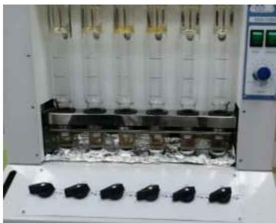
Figura 13. Determinación de componentes del rastrojo de maíz, Dosi Fiber J.P-Selecta. Fuente (Autores, 2022).
