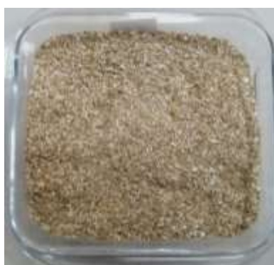
Figura 9. Molienda del rastrojo de maíz. Fuente. (Autores, 2022).
