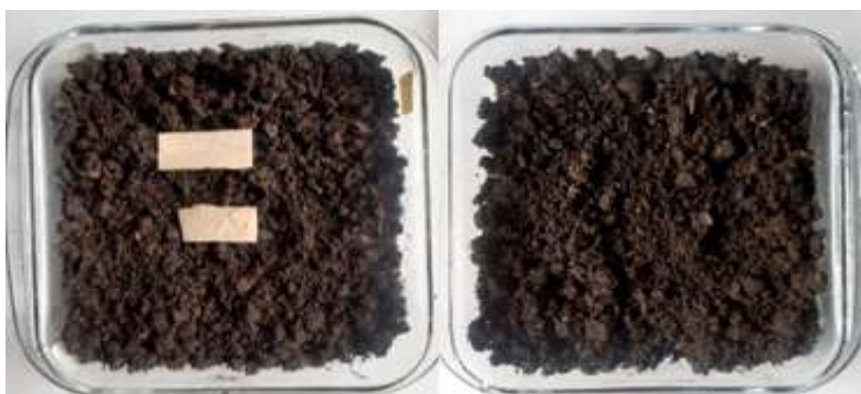
Figura 25. Muestras para el análisis de biodegradación del biopolímero. Fuente (Autores, 2022).
