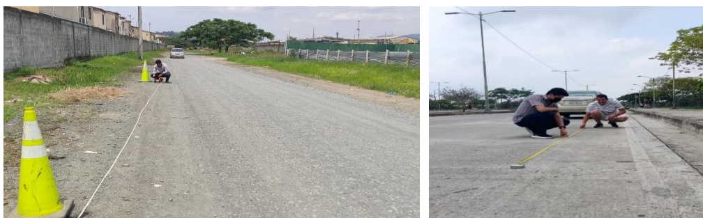
Figura 40. Medición de la distancia de frenada en los 2 escenarios de pruebas. Fuente: Autores
