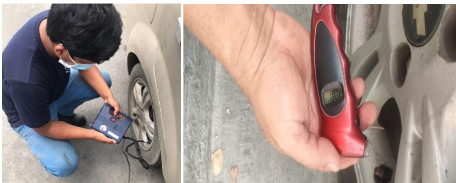
Figura 35. Verificación y medición de la presión de los cuatro neumáticos. Fuente: Autores
