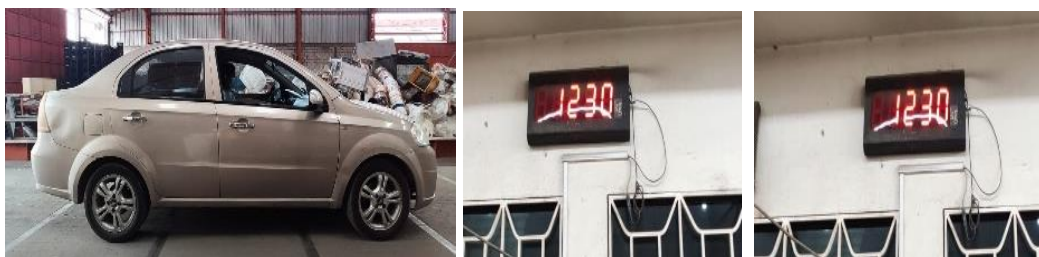
Figura 24. Toma de dos mediciones del peso total del vehículo. Fuente: Autores
