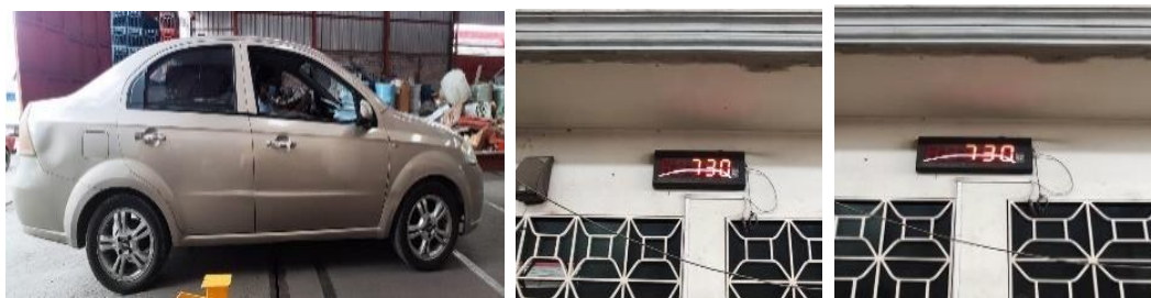
Figura 25. Toma de dos mediciones del peso del eje delantero del vehículo. Fuente: Autores
