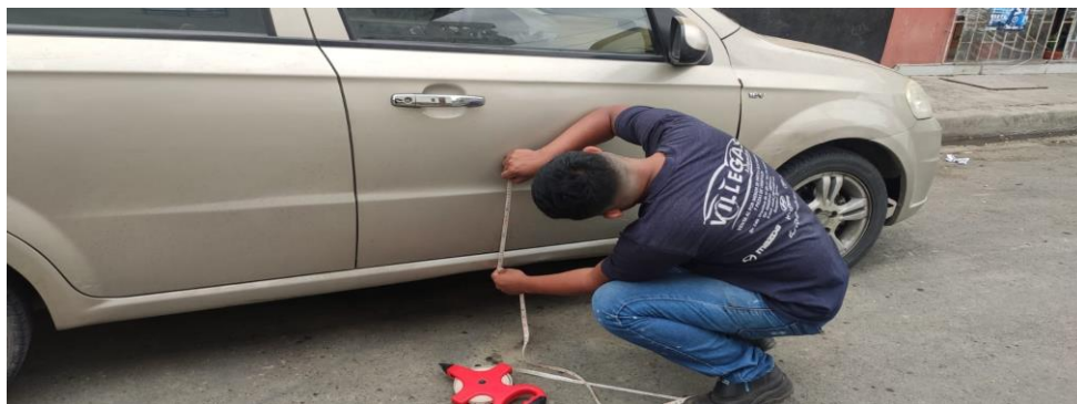
Figura 31. Determinación de la altura HT medida desde la base del carro. Fuente: Autores
