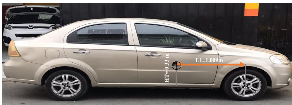
Figura 32. Ubicación del centro de gravedad en el vehículo. Fuente: Autores
