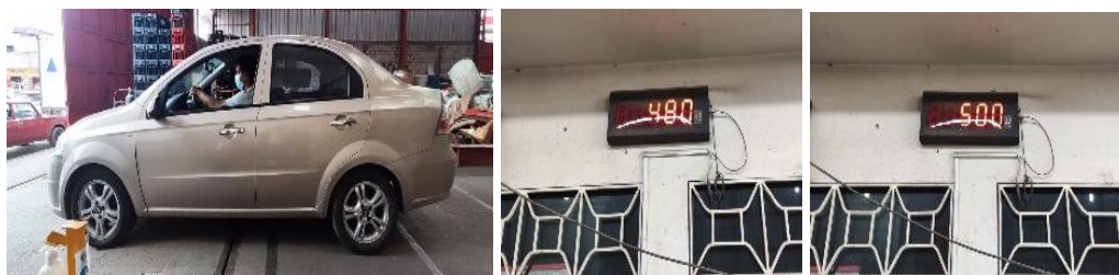
Figura 26. Toma de dos mediciones del peso del eje posterior del vehículo. Fuente: Autores
