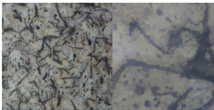
Figura 7 Matriz de la microestructura de una disco Original. Fuente. (Andrés, 2017)
