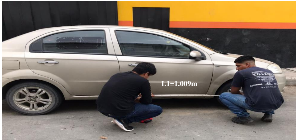
Figura 30. Ubicación de la distancia del centro del neumático delantero al centro de gravedad.
