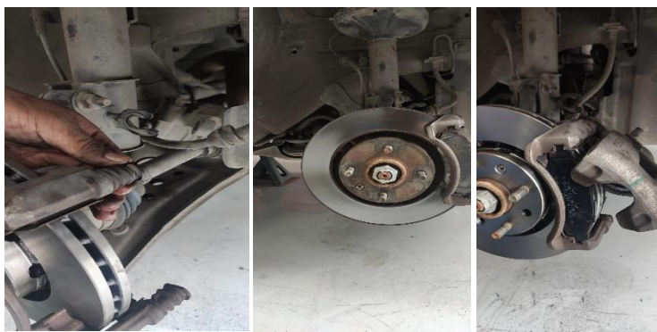
Figura 36. Limpieza de pistón de apriete e inspección de discos, cambio de discos y pastillas.
