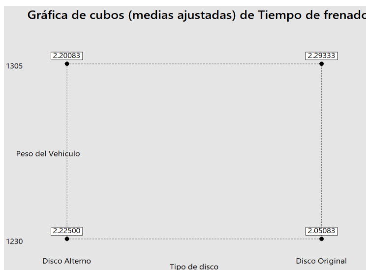
Figura 65. Diagrama de cubos del Tipo de disco x Peso del vehículo. Fuente: Autores
