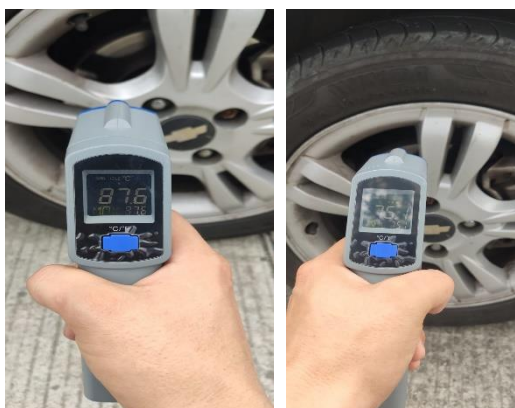
Figura 39. Verificación de la temperatura inicial del disco. Fuente: Autores
