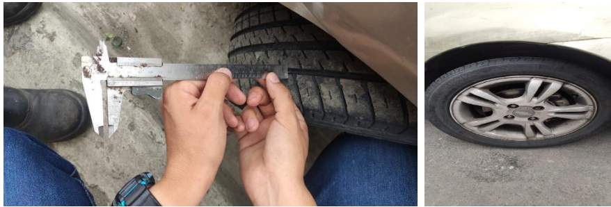
Figura 34. Profundidad de labrado del neumático. Fuente: Autores
