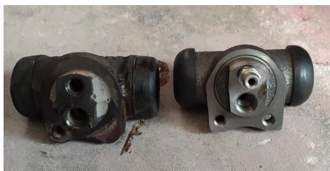
Figura 37. Cambio de cilindros de frenos posteriores. Fuente: Autores
