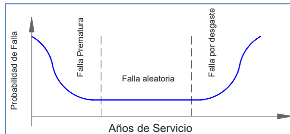
Figura 2-1. Probabilidad de falla del transformador de potencia [4].
