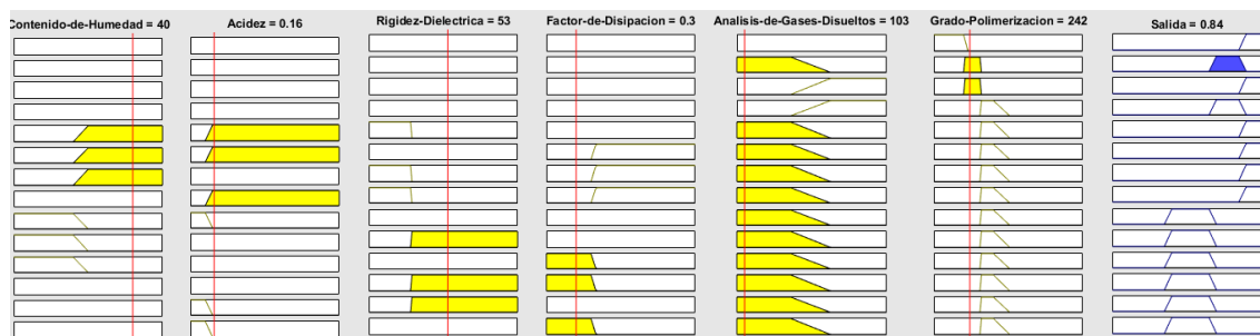
Figura 4-8. Evaluación del estado funcional del transformador #10 de la Tabla 3.1. Fuente propia.
