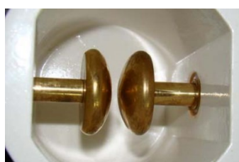
Figura 1-11. Electrodo usados en prueba de rigidez dieléctrica según ASTM 1816 [14]
