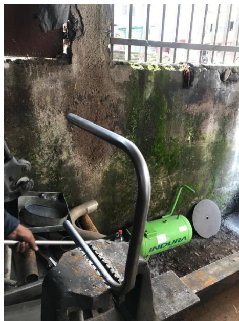
Figura (4-9). Doblado estructura de mochila exoesqueleto
