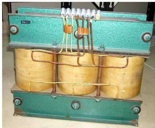
*Figura 1. 7: Transformador trifásico de tres columnas trifásico [10].*
