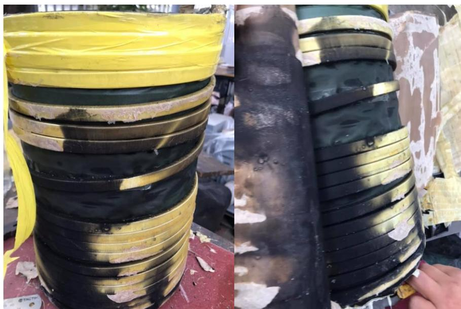
*Figura 4.18. Inspección visual del bobinado averiado.*
