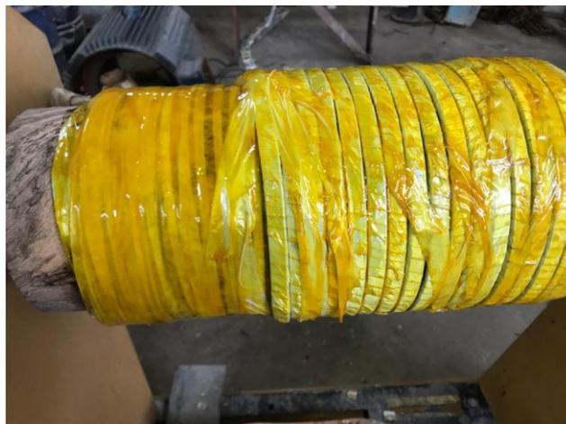
*Figura 4. 11. Demostración de la cobertura aislante del bobinado.*
