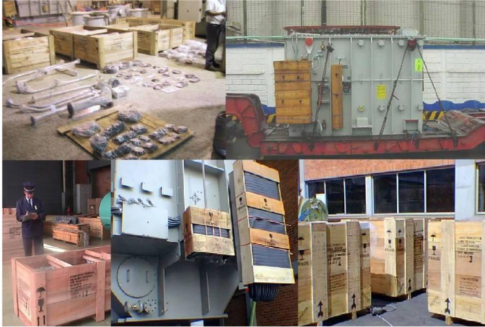
*Figura 3. 19. Verificación de elementos, inspección externa y preservación del transformador [24].*
