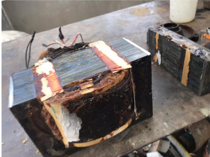
*Figura 4. 5. Desmontaje de un transformador seco de 0.5 kVA de 440/240 V*
