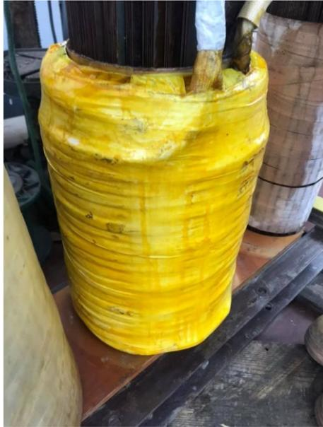
*Figura 4.21. Bobinado aislado y recubierto de barniz.*
