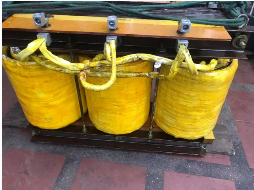
*Figura 4.23. Bobinas montadas en el núcleo, listo para realizar pruebas.*
