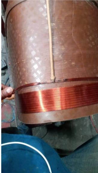
*Figura 4. 15. Rebobinado del transformador trifásico.*
