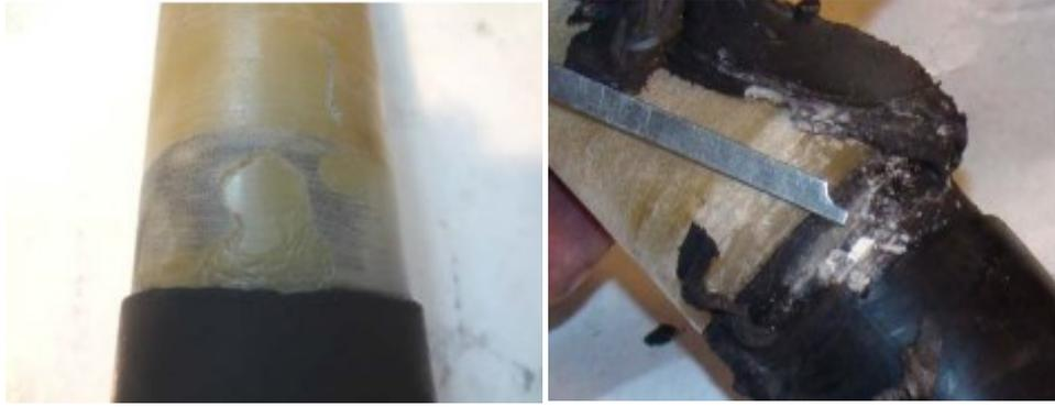
*Figura 2.6: Puntas de media tensión defectuosa con degradación del aislamiento y carbonizada entre la masilla y la capa semiconductor externa.*
