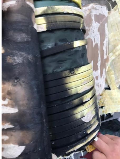
Figura 2.7: Devanados dañados por sobrecalentamiento.
