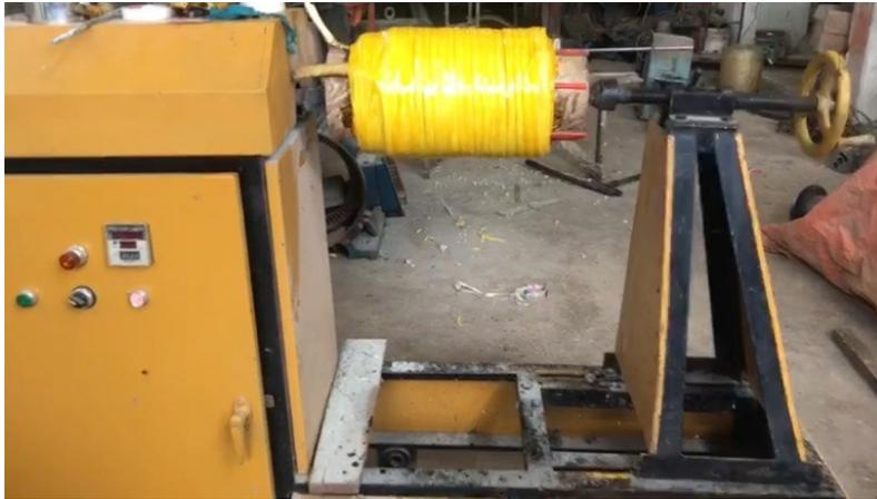
*Figura 4. 9. Bobinado del transformador*
