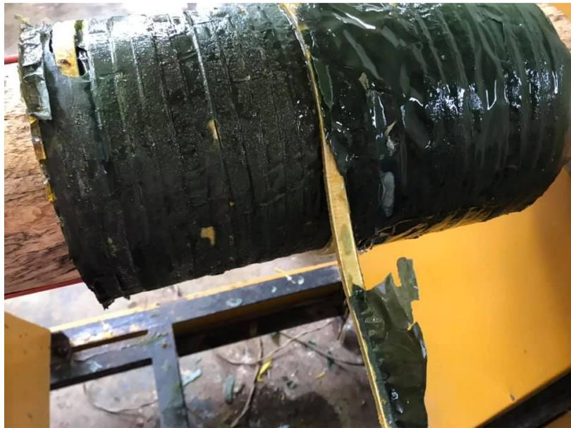
*Figura 4.20. Desenrollo del alambre de la bobina quemada.*
