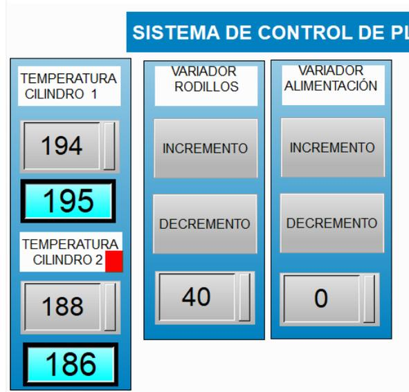
**Figura 54.** interfaz de HMI para visualizar la temperatura censada (Autor)
