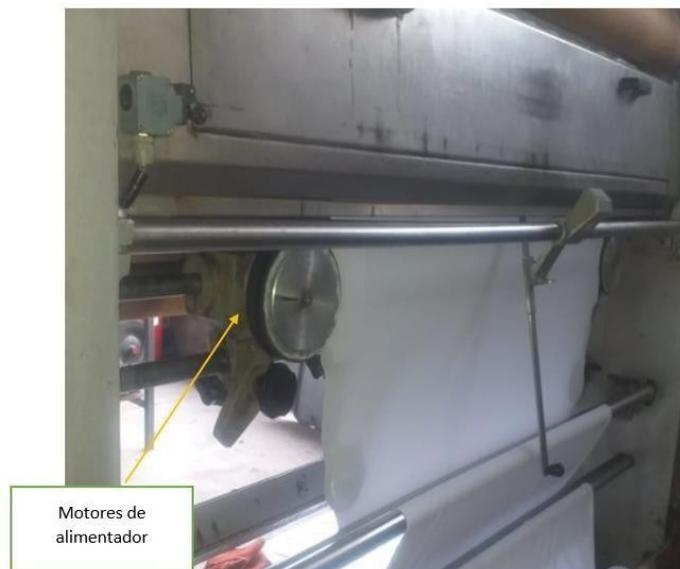
**Figura 44.** alimentador de la máquina (Autor)
