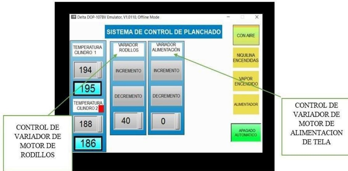
**Figura 52.** sistema de variación de frecuencia por HMI (Autor)
