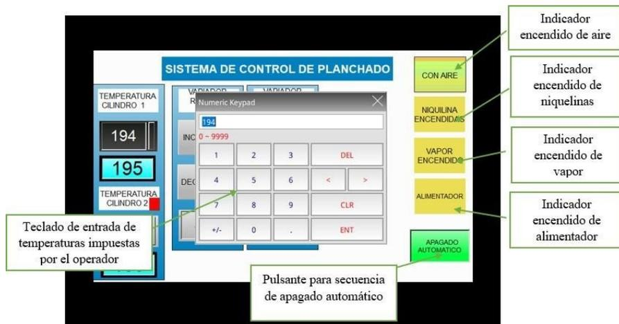
**Figura 32.** Interfaz de control por HMI (Autor)
