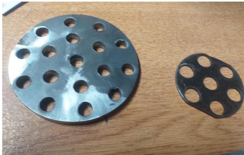
**Figura 25.** placa de sellado de cilindro de niquelinas rectificado (Autor)
