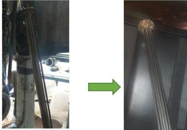
**Figura 26.** Niquelina desmontada con falla (Autor)
