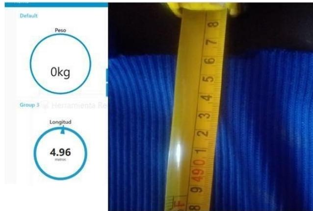
**Figura 37.** comparación de medida obtenida en software y medida artesanal (Autor)
