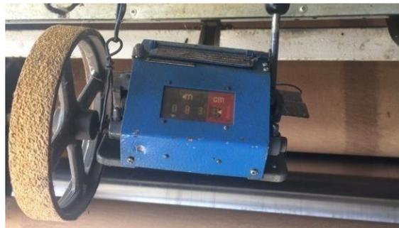
**Figura 4.** Rueda de Medición de Longitud (Autor)
