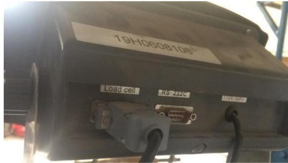
**Figura 56.** comunicaciones RS 232 de la balanza (Autores)
