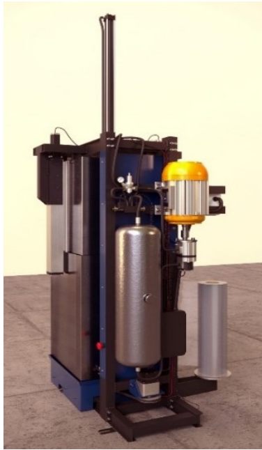
Figura 3.36. Renderizado de los elementos oleo-hidráulicos.
