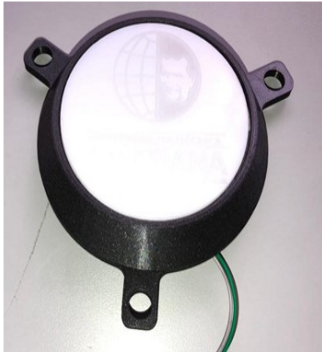
Figura 133: Módulo led apagado
