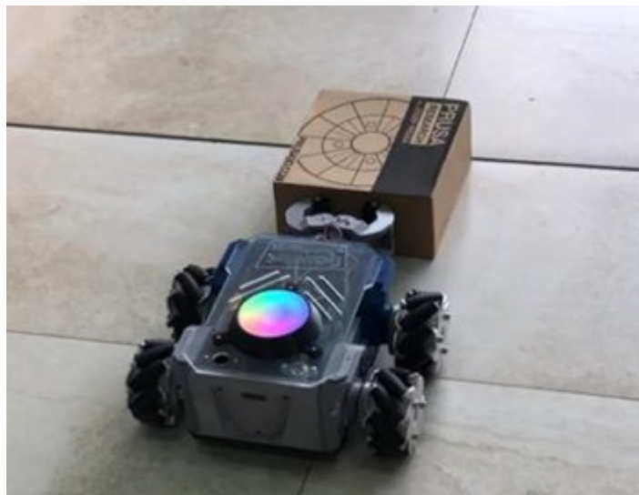
Figura 124: Robot en movimiento empujando 1kg de peso.
