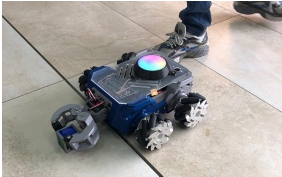
Figura 127: Módulo del efector final en funcionamiento
