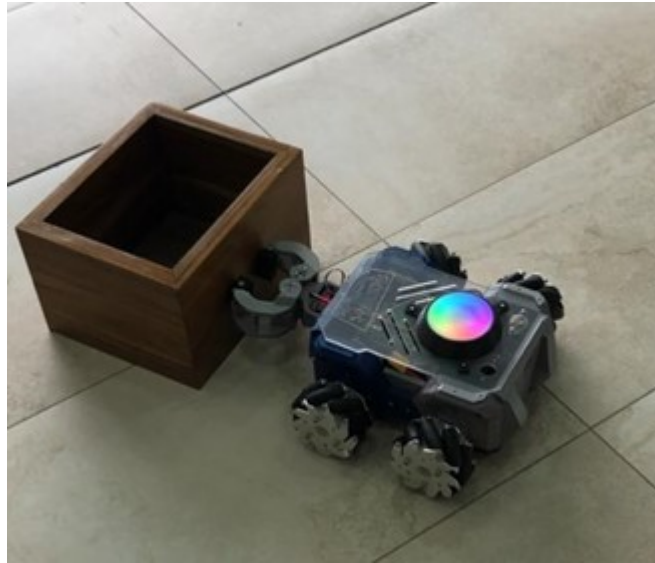
Figura 125: Robot en movimiento empujando 1.8kg de peso.
