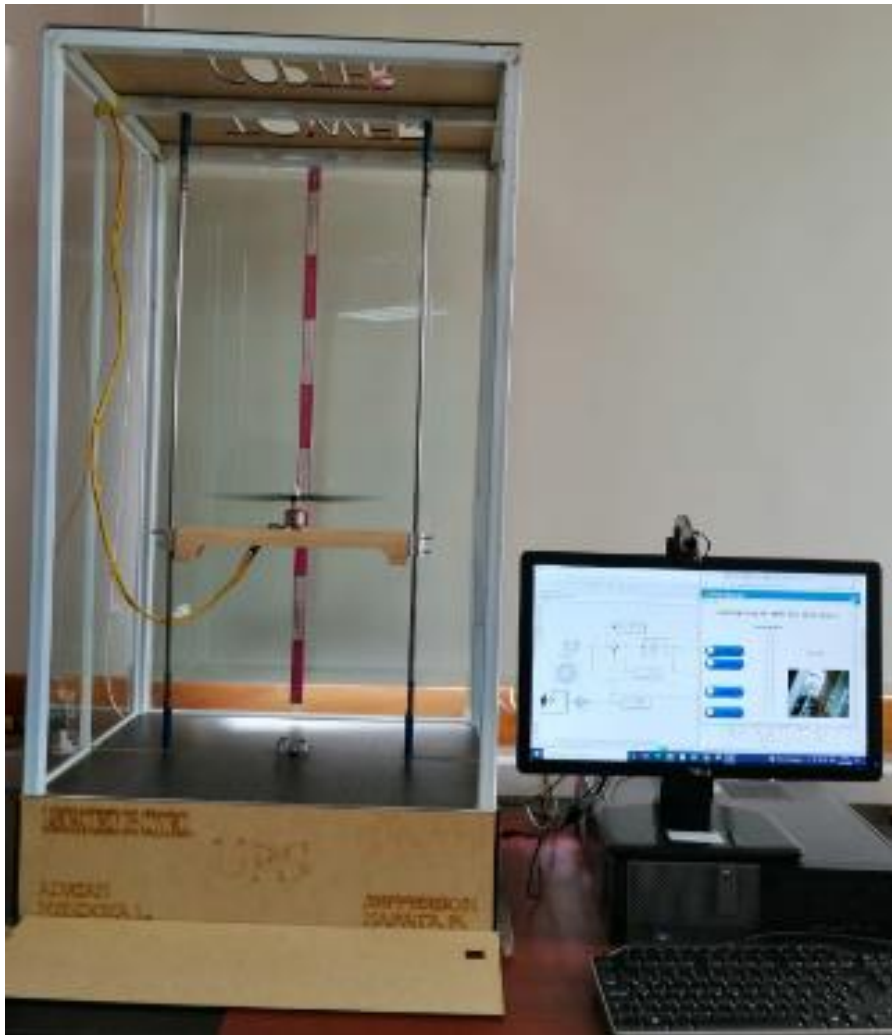
Anexo.3. Sistema VTOL en funcionamiento en una altura de 30 cm
