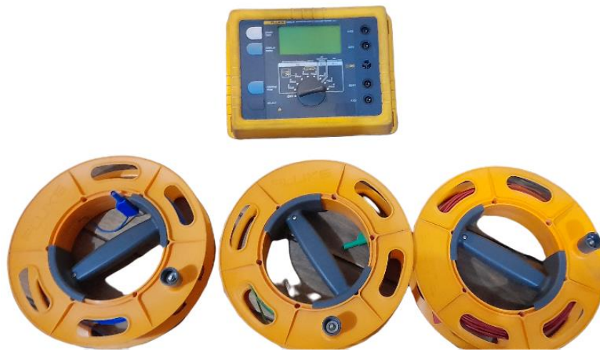
Figura 31. Elementos indispensables para el telurómetro.
