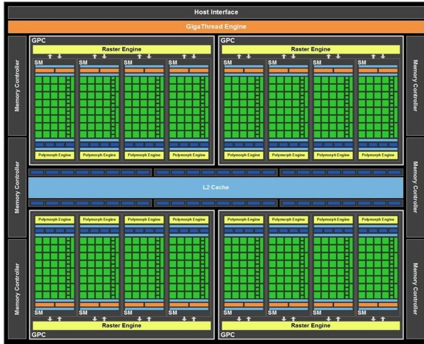
Figura 3.1: Detalles de la arquitectura Nvidia GF100 [1]
