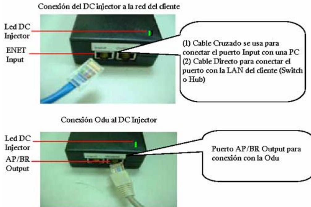
Fig. 40 Modem de un enlace de radio MTI
