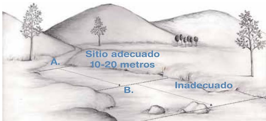
Figura 6. Selección de sitio adecuado para medición de velocidad del cauce [27].
