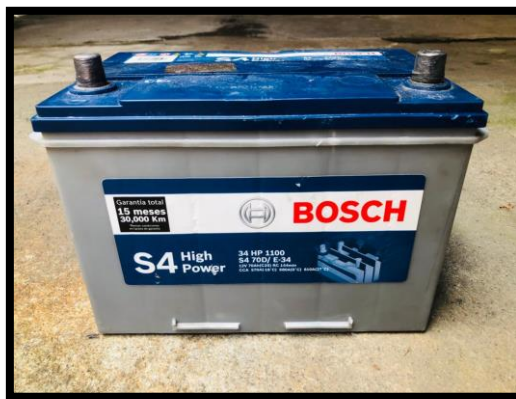
Batería de ácido-plomo de la marca Bosch con 12V y 77Ah, Erick Anchali, David Estrella.
