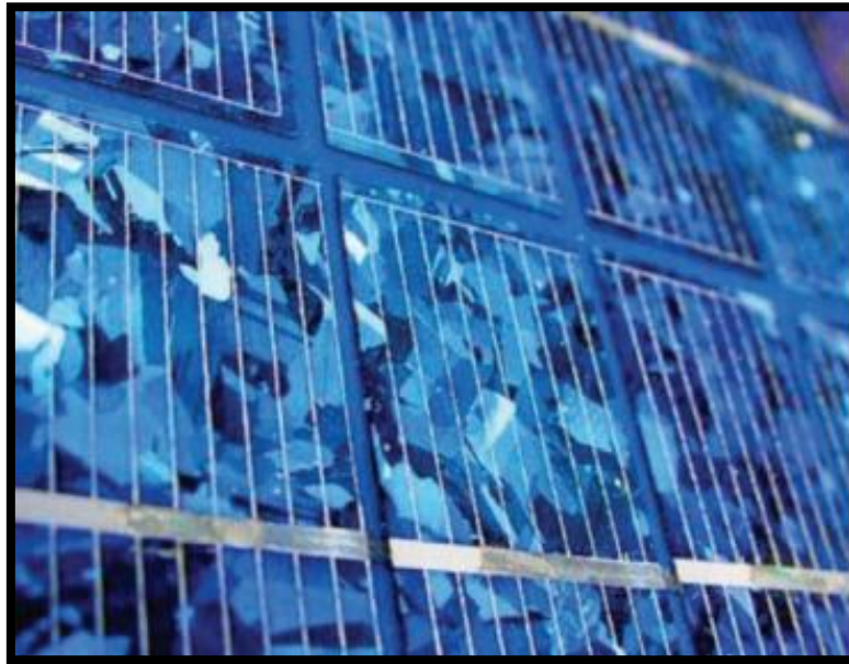
Conjunto de celdas fotovoltaicas para formar un panel. Fuente: (Bulnes Y Best, 2010)
