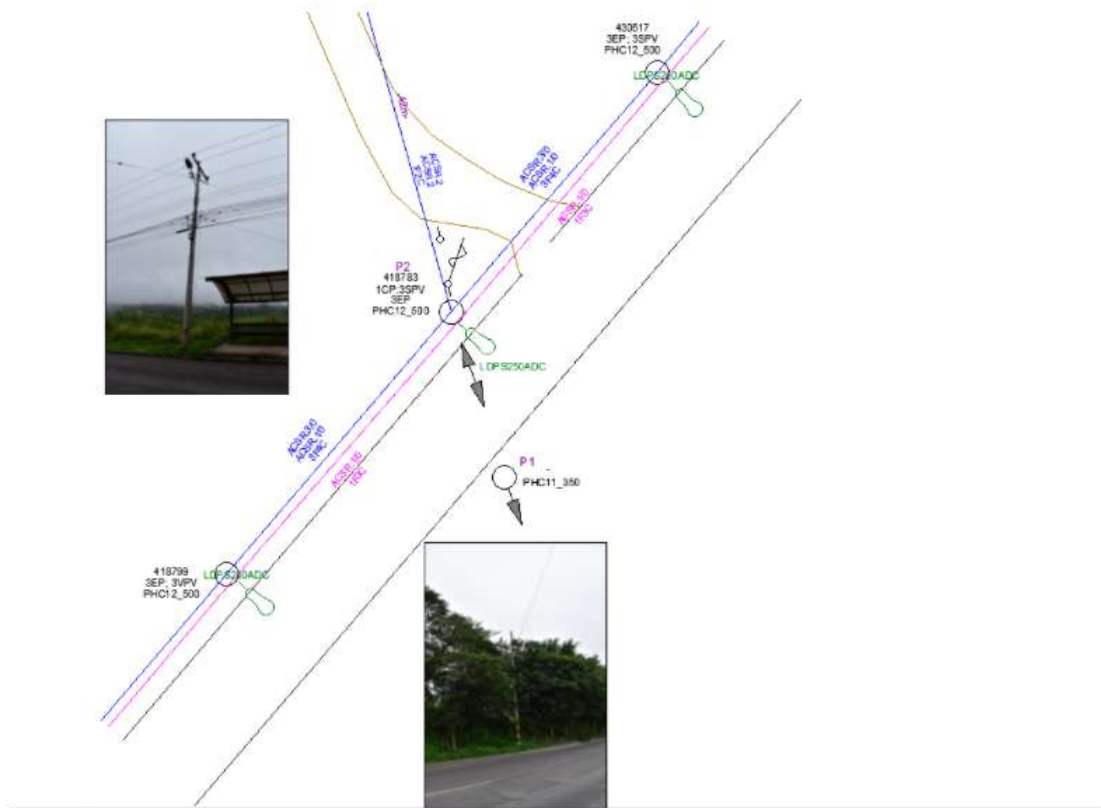
Figura 27: Plano de la Red Existente con Fotografías de los Postes
