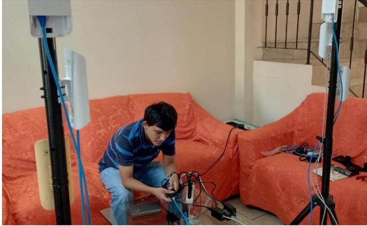
Figura 4.9 Conexión de cables en POEs
