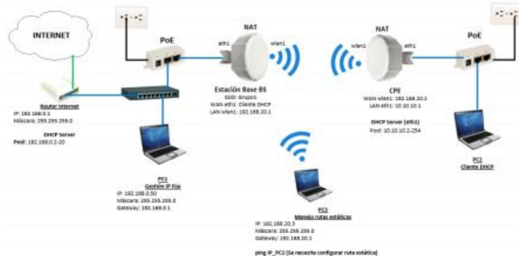
La estación base y el CPE deberán formar un enlace Capa 3 y entre la PC3 y PC2 conectadas en cada extremo del enlace se deberá realizar el ruteo necesario para que se puedan comunicar.
