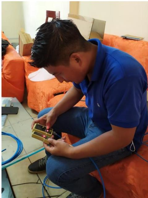
Figura 4.14 Comprobación con test UTP.
