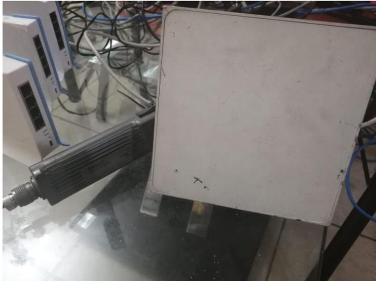
Figura 4.26 Mikrotik Metal 5 con antena sectorial
