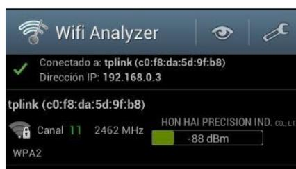
El SSID no es detectado ya que Ubiquiti trae en sus equipos activado por defecto el protocolo propietario AirMax el cual hace más eficiente los enlaces al utilizar el protocolo TDMA (Time Division Multiple Access), la transmisión es controlada directamente por el AP asignando espacios de tiempo a cada usuario para que pueda transmitir, mejorando así la eficiencia del enlace y el uso del canal, eliminando cabeceras innecesarias que son utilizadas en el protocolo Wifi utilizado habitualmente.
