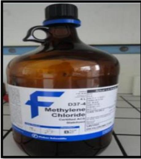
Reactivo utilizado como solvente para la determinación de TPH
