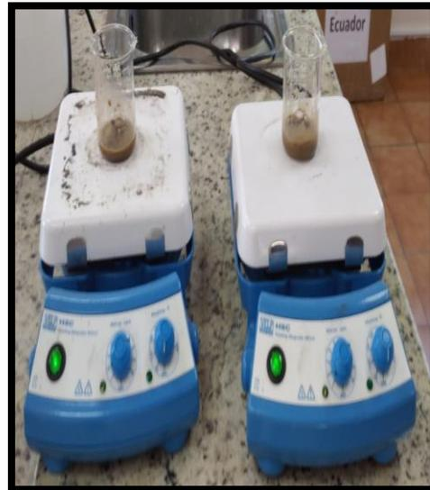
Se coloca 10 ml de agua destilada, se agita por durante 30 min.
