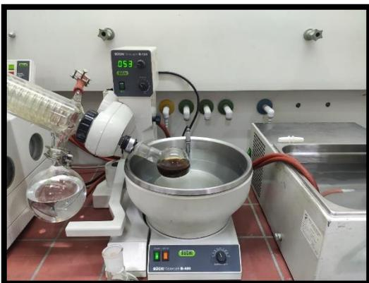
Se pasan los balones al rotaevaporador para la recuperación del disolvente.
