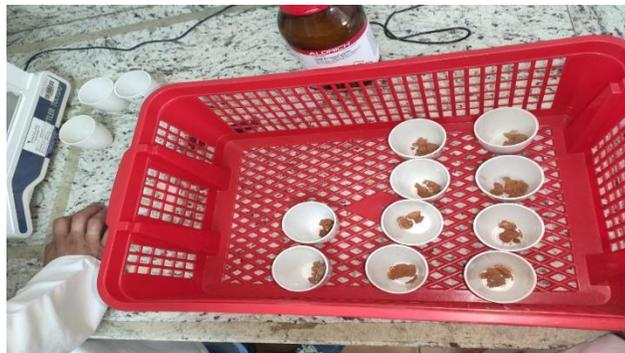
Muestras después de a ver estado en el desecador por 30 min.
