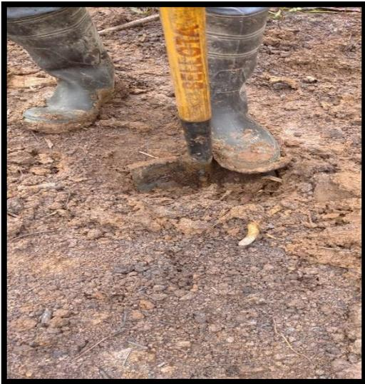
*Se introduce la pala hasta 20 cm de profundidad.*
