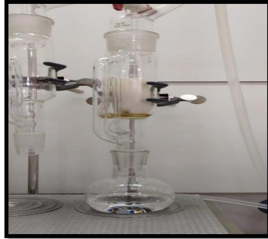
Conectar los balones al extractor soxhlet, con 300 ml de disolvente durante 8 horas.
