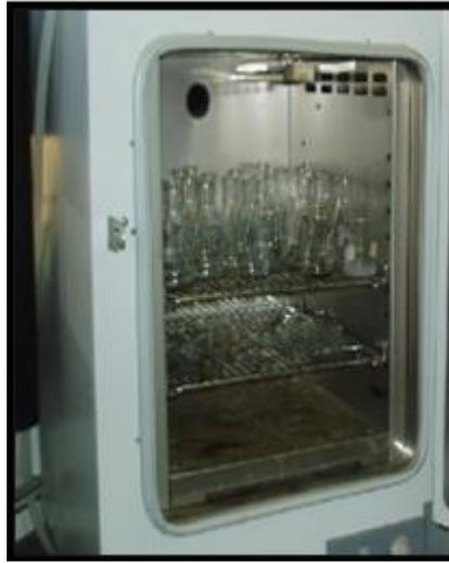
Se colocan los balones dentro de la estufa a 120 °C, para llegar a un peso contante.
