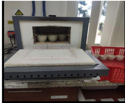
Calcinación de la muestra en una mufla a 700 °C , durante 4 horas.
