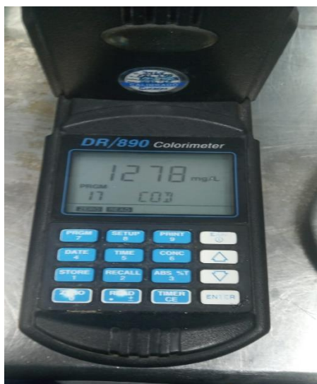
Figura 17. Colorímetro portátil DR/890 equipo utilizado en la experimentación.
