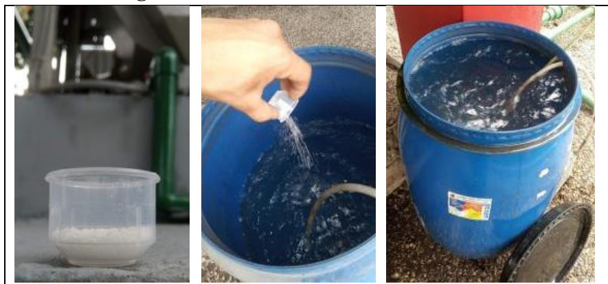
Figura 8. Proceso de dosificación de floculante.
