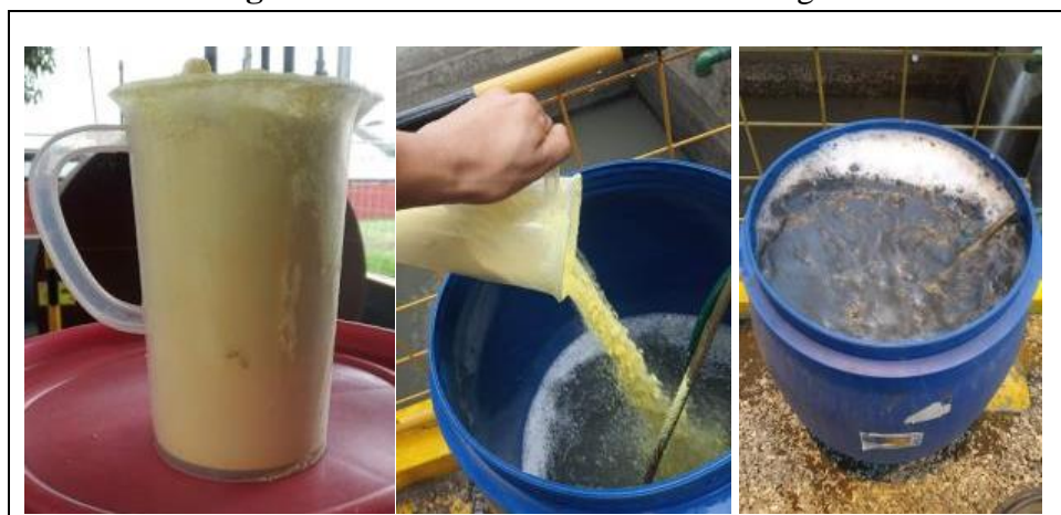
Figura 9. Proceso de dosificación de coagulante.
