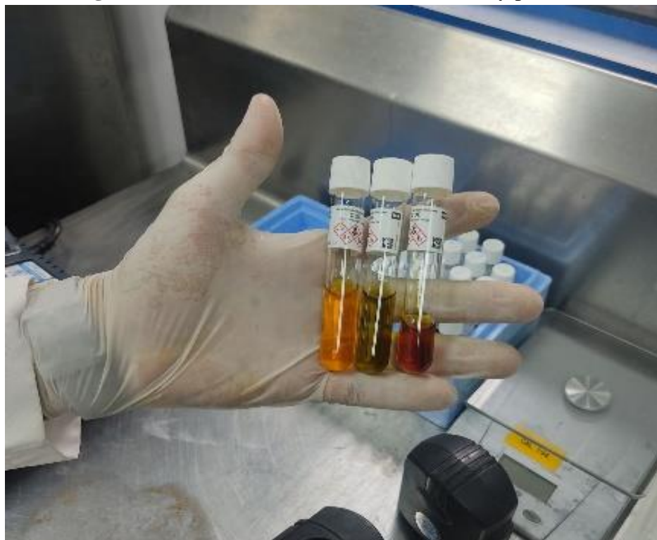
Figura 45. Muestras de viales de DQO blanco y positivo.
