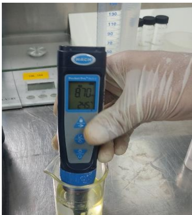
Figura 35. Equipo potenciómetro HACH portátil pocket pro+
