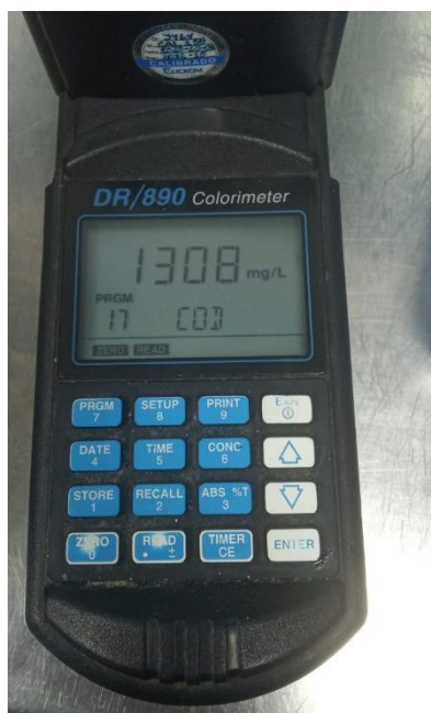
Figura 4. Toma de muestra con Colímetro portátil (Modelo DR/890)
