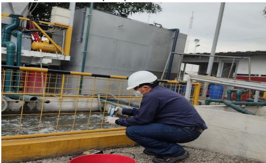
Figura 42. Análisis de pH en piscina de sub tratamiento de PTAR.
