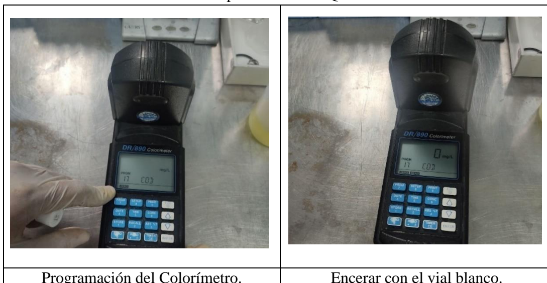
Figura 47. Procedimiento con el equipo colorímetro para la obtención de resultados del parámetro de DQO.
