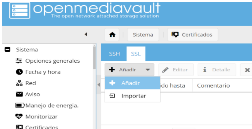
Figura 78. OpenMediaVault – Crear Certificados de Seguridad, (Print Screen)
