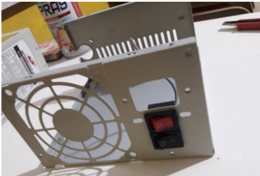
Figura 39. Pintura y Acabado Final de la Estructura Metálica.
