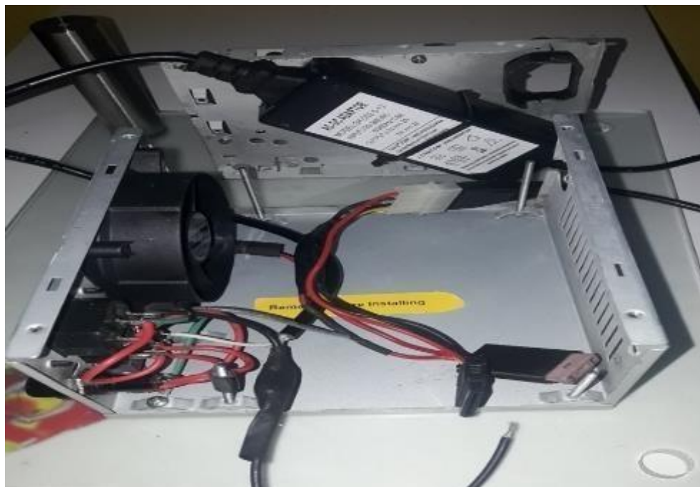
Figura 42. Conexión de la Fuente de Alimentación del Disco Sólido SSD. Fuente: Propia del autor.
