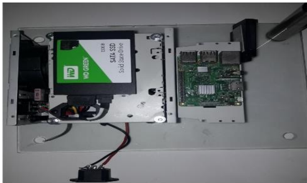
Figura 45. Conexiones de la SSD - Comunicación del Convertidor Serial ATA.
