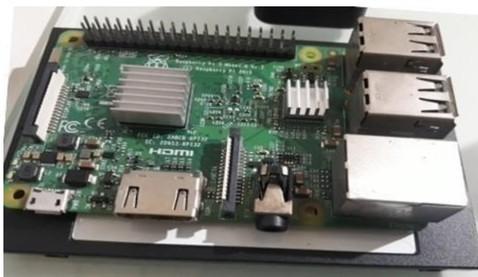
Figura 43. Sujeción de la Raspberry Pi en la Estructura Metálica. Fuente: Propia del autor.
