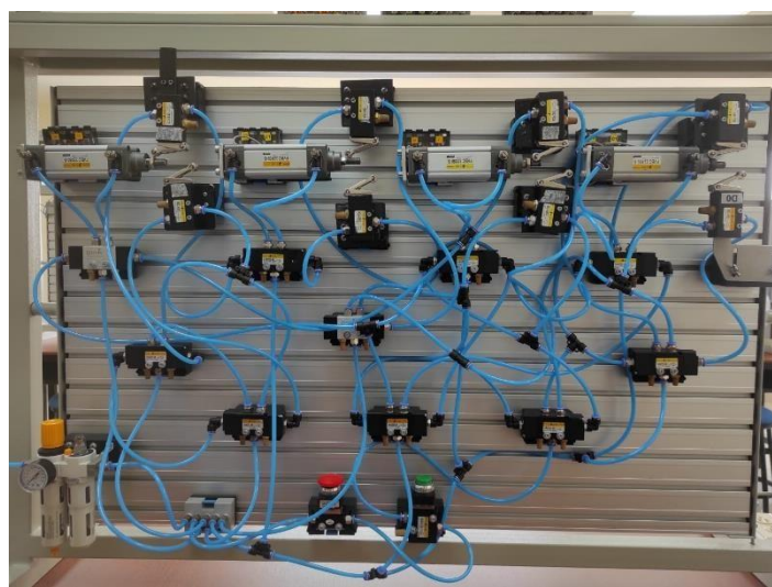
Figura 139. Implementación Neumática en el módulo
