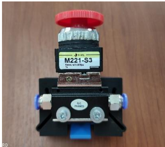
Figura 32. Válvula de paro de emergencia.
