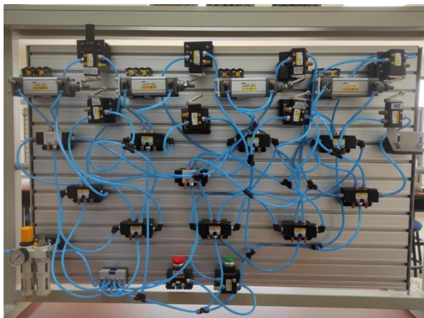
Figura 163. Implementación Neumática en el módulo
