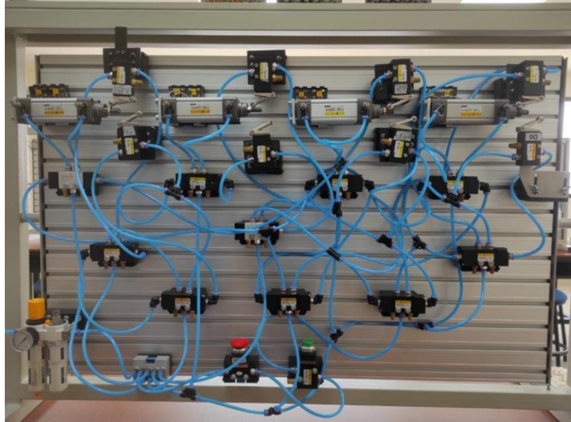
Figura 151. Implementación Neumática en el módulo
