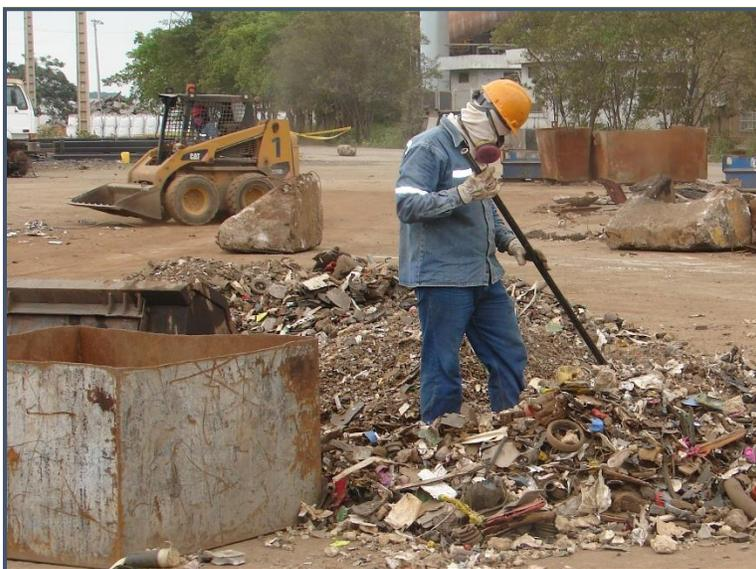
**Figura PMP.6 – Separación de Material No Ferroso y No Metálico.**
