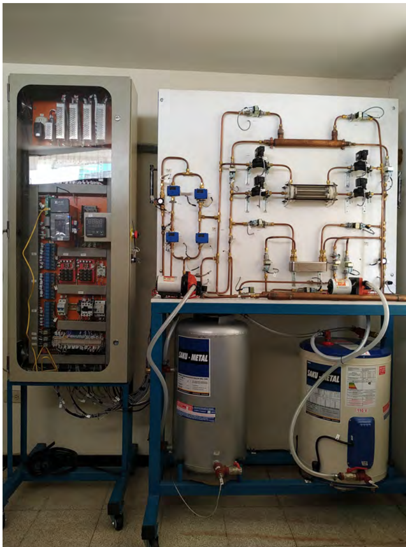
Figura 5.5: Sistema Integrado de Monitoreo y Control.
