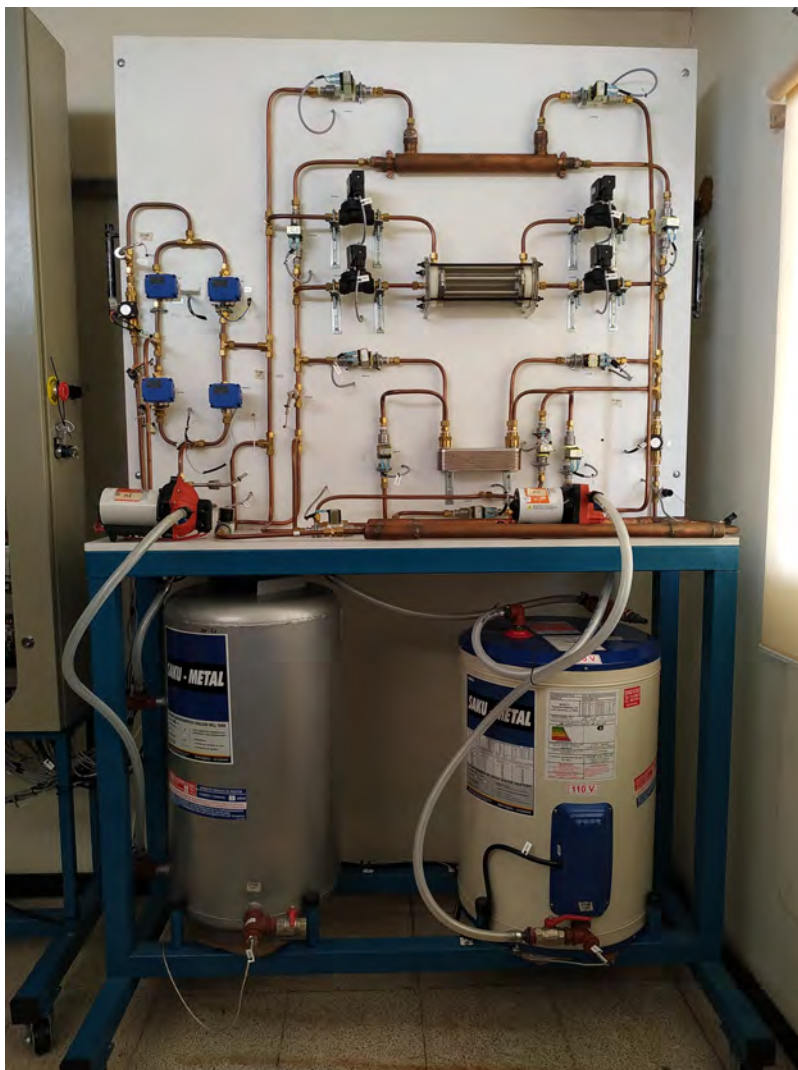
Figura 5.3: Banco de Pruebas de Intercambiadores de Calor.
