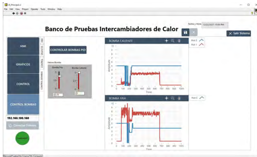
Figura 3.11: Interfaz - Control de Bombas.
