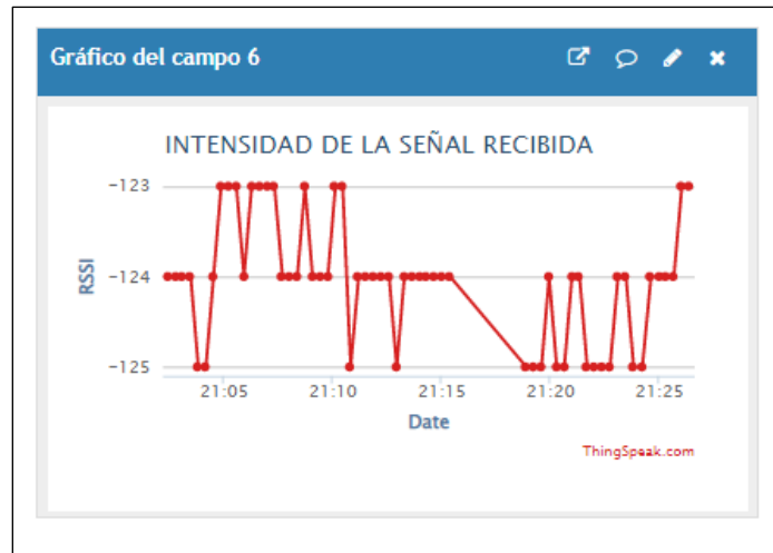
Figura 54 Monitoreo de la intensidad de la señal de LoRa.
