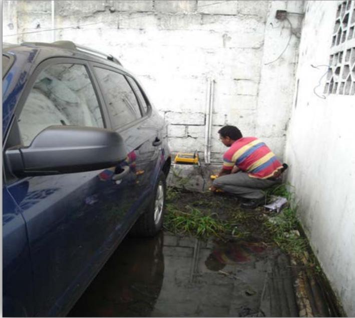
Para poder obtener una excelente lectura en equipo fluke 1625 los ganchos tienen que estar separados a una distancia aproximada a 10 cmt en posición 3 pole conectando los tres cables en terminales H,S,T del equipo. El terreno en donde se encuentran enterradas estos electrodos es húmedo y fangoso las cuales tubo las siguientes medidas de resistividad.
