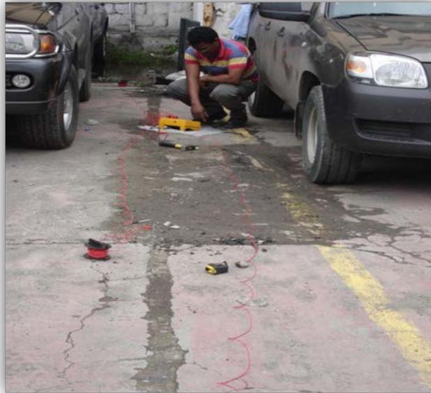
*FIGURA 67.- Posición de las picas para la medición de la resistencia del terreno*
