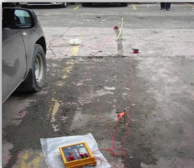
FIGURA 68.- *medición de la resistencia del terreno mayor distancia ( 4m)*
