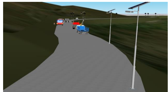
Figura 18. Disposición de luminarias en la vía E487 georreferenciada
