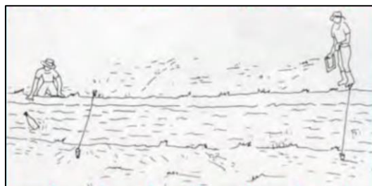
Ilustración 9: Medición de la velocidad
