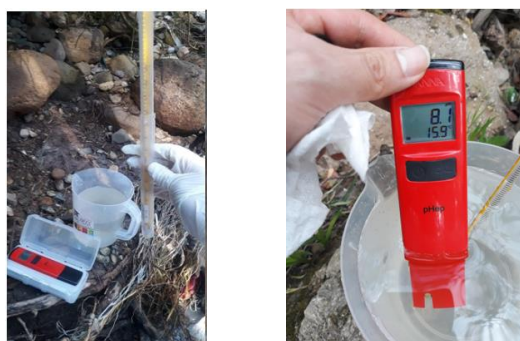
Ilustración 18: Medición in-situ de la temperatura y pH.
