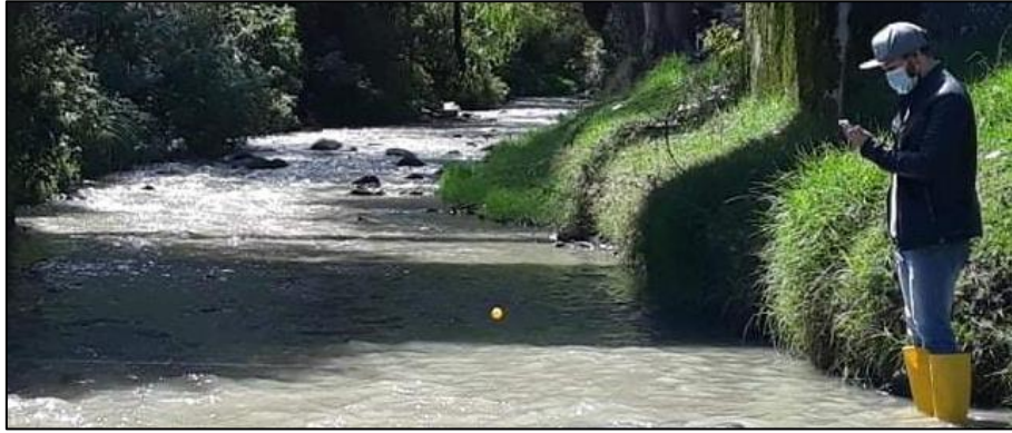
Ilustración 15: Estimación de la velocidad del flotador en los diferentes tramos del río.
