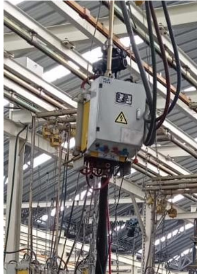
Figura 21. Soldadura de punto baja frecuencia.
