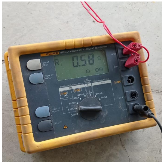
Figura 36. Medición de puesta a tierra área de soldadura.
