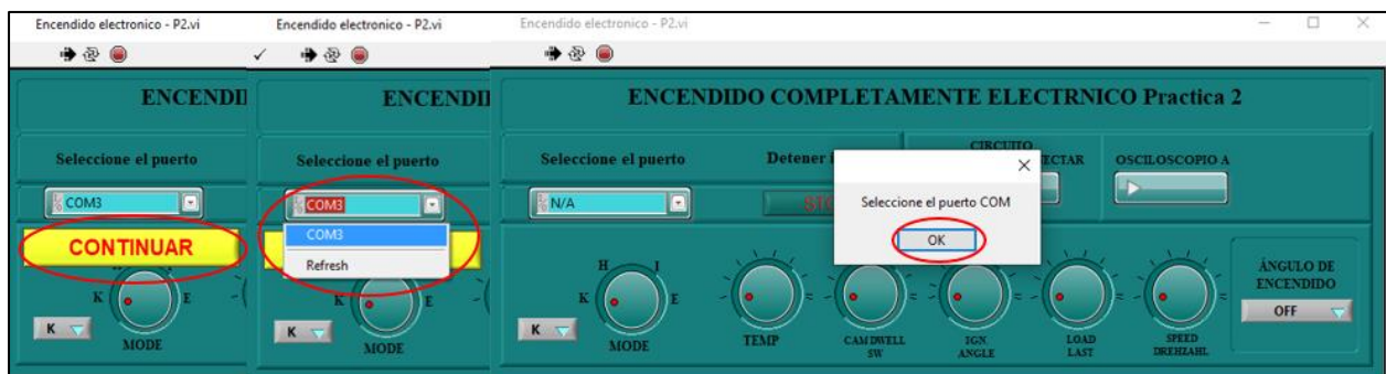
Fig. 46 Selección del puerto COM para la comunicación del software con el hardware
