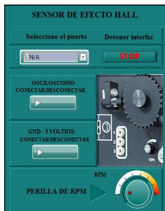
Figura 67: Panel del Sensor de Efecto Hall
