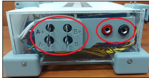
Figura 91: Pines de Conexión Hacia los Canales del Osciloscopio y Salidas para el Multímetro
