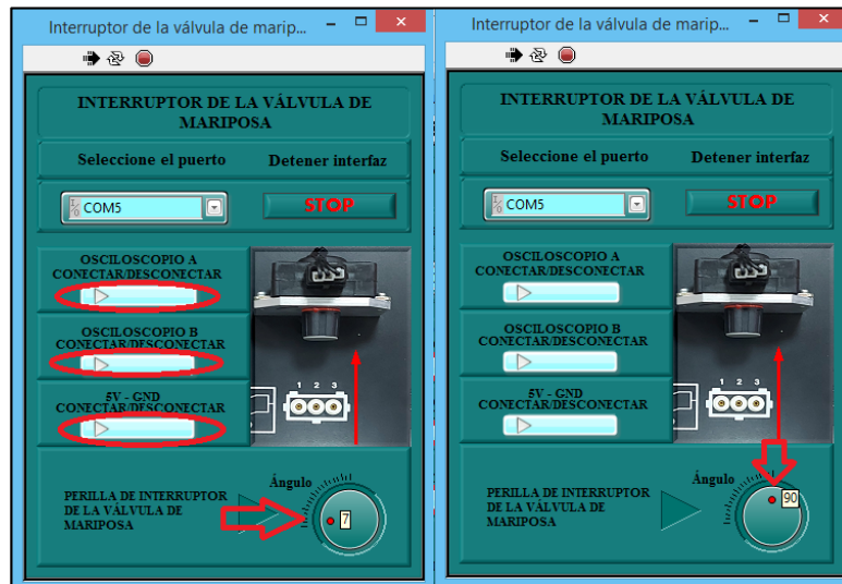
Fig. 45 Puesta en marcha del interruptor de la válvula de mariposa mediante el software remoto
