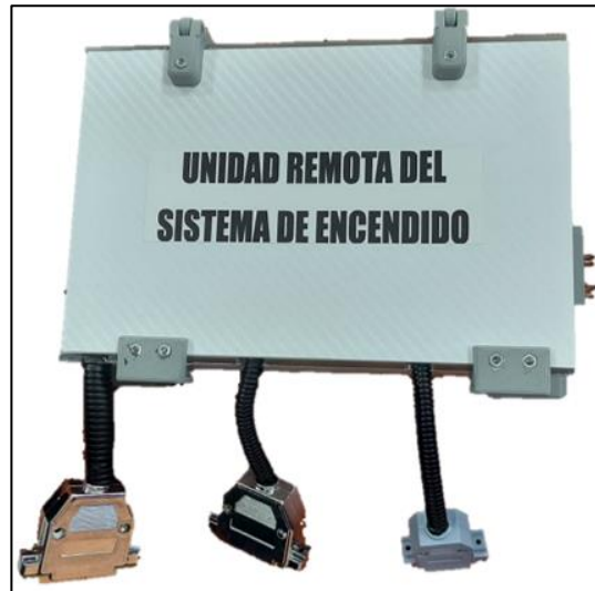
Figura 42: Unidades Remotas para los Módulos de Encendido y Sensores
