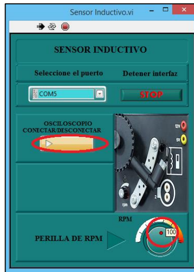
Fig. 37 Puesta en marcha sensor inductivo mediante el software remoto
