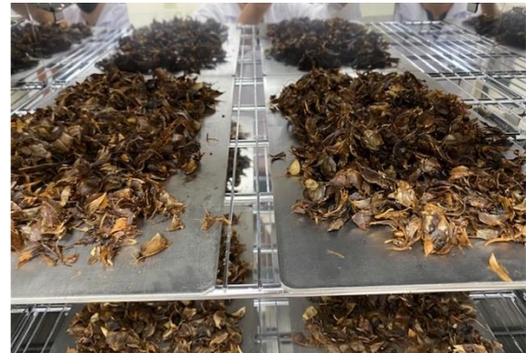
Figura 2. Secado de la fibra a 80°C por 20 minutos.
