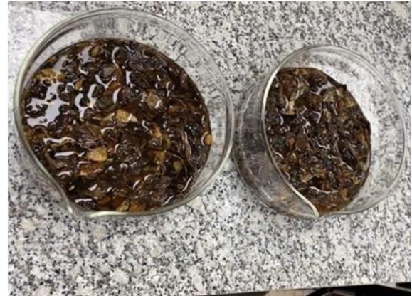
Figura 1. Fibra de gandul en solución de hidróxido de sodio al 0.1 molar.
