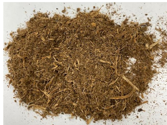
Figura 3. Partículas de cáscara de gandul de 3-4 mm de tamaño aproximadamente
