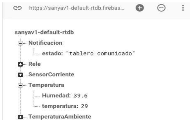
Figura 4.22: Nodo sensor temperatura y humedad del tablero.
