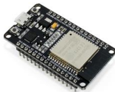
Figura 2. ESP32-NODEMCU-32. Fuente: (Naylamp, 2020).
