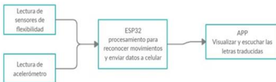
Figura 3 Diagrama de bloques del guante electrónico.
