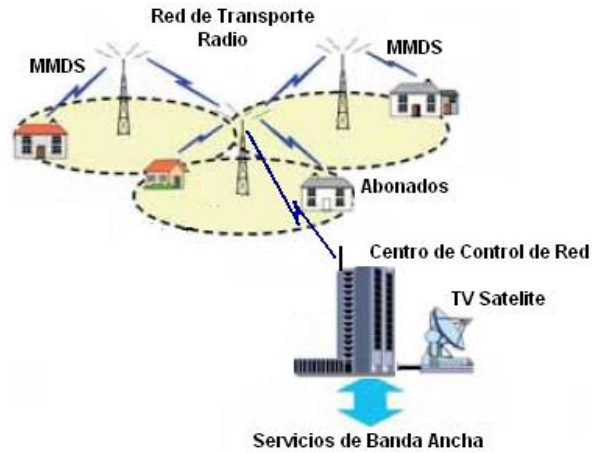
Figura. 1.3.4.2.1. Topología de Interconexión inalámbrico para sistema MMDS.
