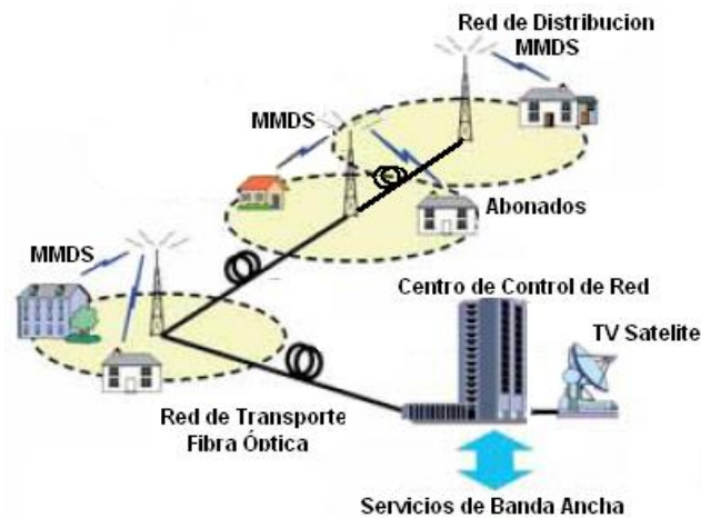
Figura. 1.3.4.1. Topología Fibra-Inalámbrico para sistema MMDS.
