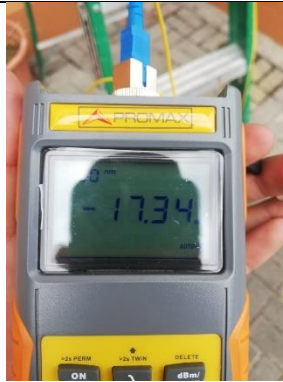
Figura 115 Potencia en el OPM de la NAP A02 [-17.34 dBm].
