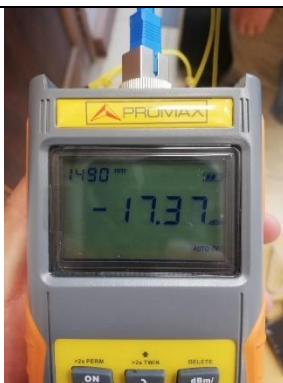
Figura 119 Potencia en el OPM de la NAP A08 [-17.37 dBm].
