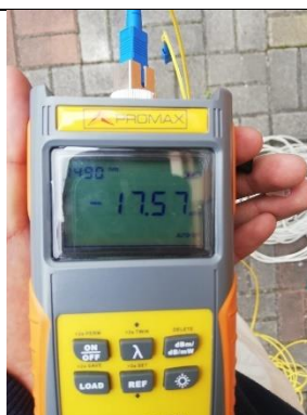
Figura 117 Potencia en el OPM de la NAP A06 [-17.57 dBm].
