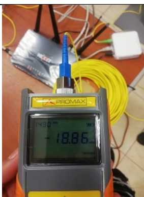
Figura 118 Potencia en el OPM de la NAP A07 [-18.86 dBm].
