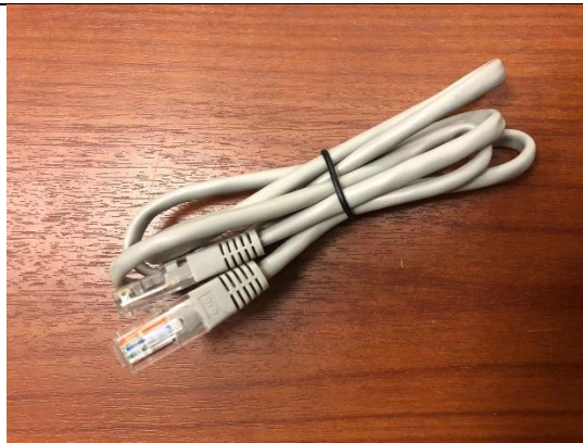
Figura 100 Cable de red.
