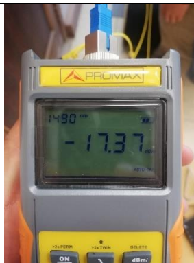
Figura 116 Potencia en el OPM de la NAP A03 [-17.37 dBm].
