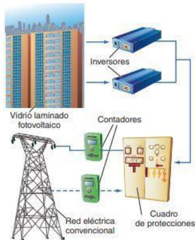
Figura 16. Sistema FV acoplado a la red [36].
