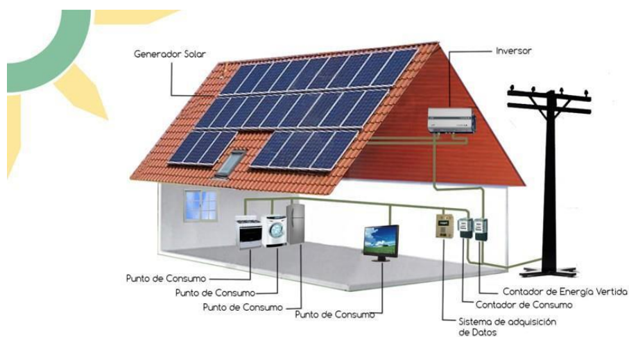
Figura 8. Energía solar fotovoltaica [18].
