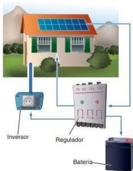
Figura 17. Sistema fotovoltaico autónomo [36].
