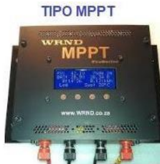
Figura 26. Controlador tipo MPPT [44].
