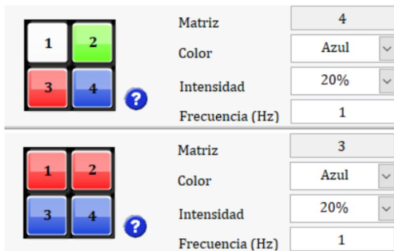
*Figura 3.1. Configuraciones del estimulador visual para prueba de modo individual usando colores distintos en cada matriz (superior) y un color por pares de matrices (inferior)*
