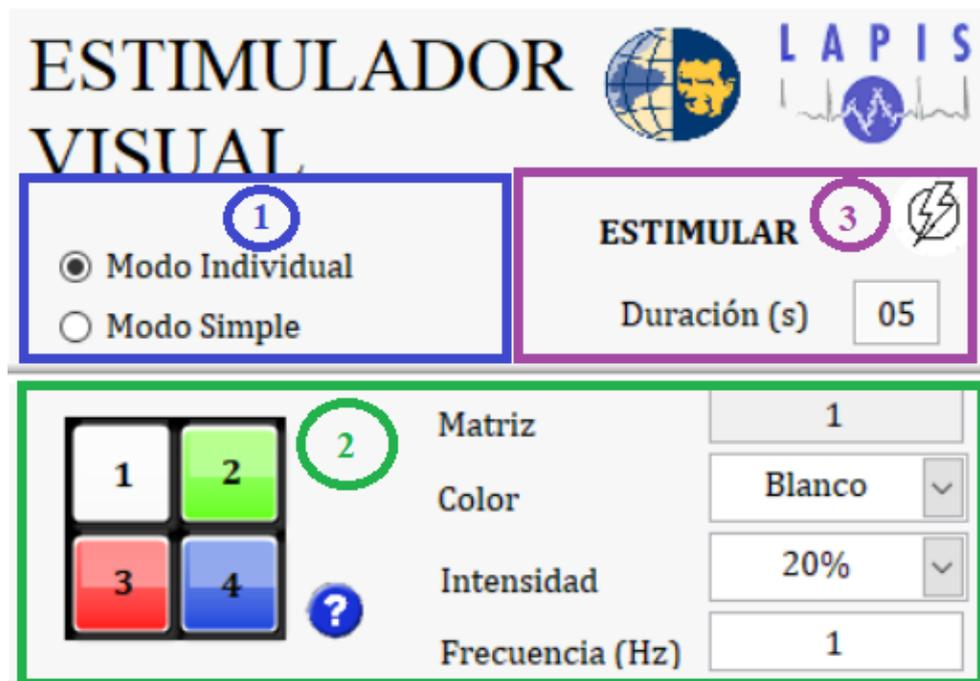
Figura *¡Error! No hay texto con el estilo especificado en el documento..169*. Interfaz del estimulador visual generada en LabVIEW y dividida en sus respectivas secciones.
