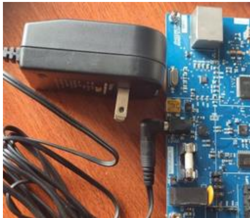
Figura 1. Conexión de regulador de voltaje con el módulo de estimulación y la red eléctrica.
