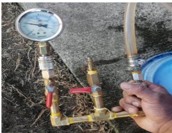
*Nota.* Manómetro utilizado para realizar mediciones de presión. Elaborado por: El autor.
