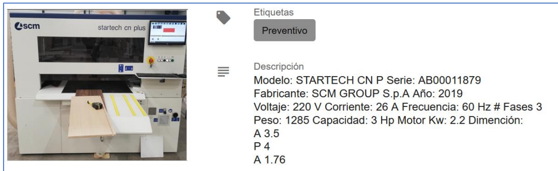
Figura 21: Centro de mecanizado SCM.
