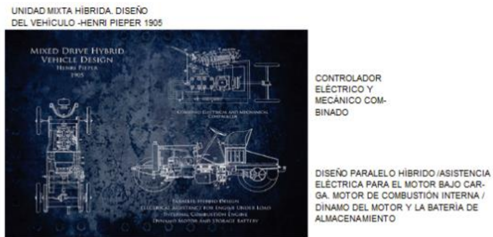
Figura. 1-2 Diseño vehículo híbrido de Henri Pieper. Fuente: (Castillo J. , 2020) .
