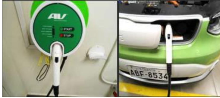
Figura. 1-29 Cargador (EVSE) de la batería de polímero de Iones de Litio. Fuente: (Guerrero, 2018).
