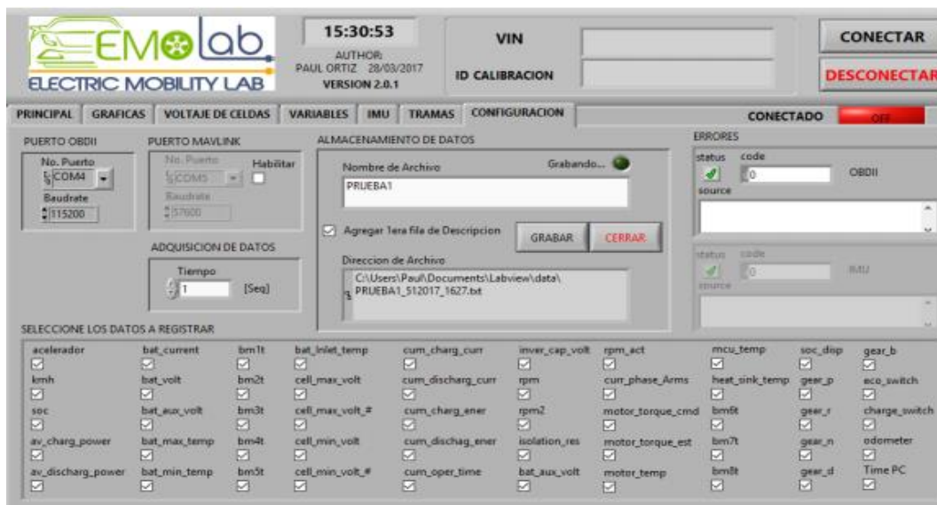
Figura. 3-2 pantalla de software de EMOLAB V2.0.1 Fuente:( Bustamante & Llumi; 2021)
