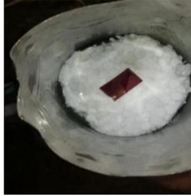
*Imagen 15:* Detector LR-115 sobre el espuma Flex
