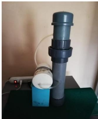
*Imagen 22:* Equipo para la medición de la exhalación de  $^{222}\text{Rn}$  de la leche de vaca
