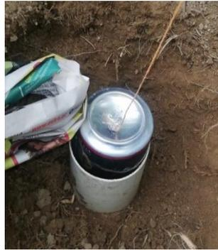
*Imagen 16:* Lata con el detector contenido del tubo PVC
