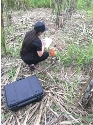
*Imagen 9: Medicion de  $^{238}\text{U}$ ,  $^{232}\text{Th}$  y  $^{40}\text{K}$*
