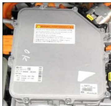
Figura 12. Bloque de conexiones de alto voltaje. Fuente: (Julio Maurad, 2018)
