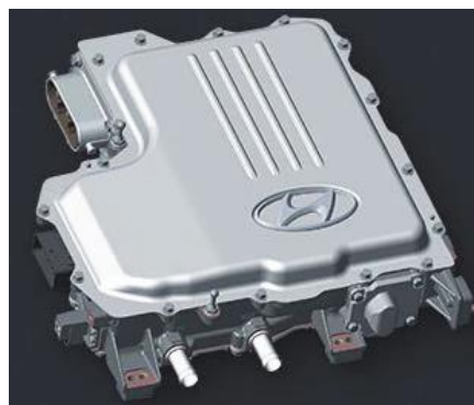
Figura 13. Distribución del sistema de bloque de conexiones de alto voltaje del KIA SOUL. Fuente: (Julio Maurad, 2018)
