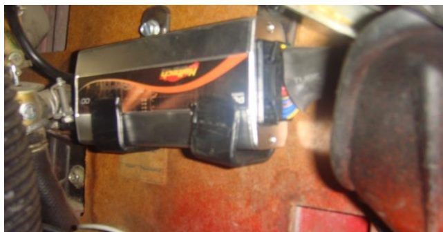
Figura 3.44 Ubicación de la Ecu en el Vehículo
