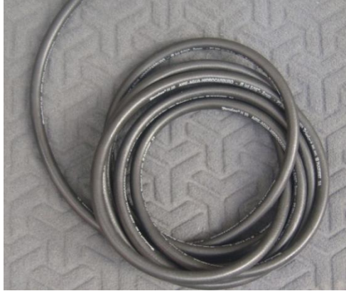
Figura 3.11 Cañerías de Combustible Fuente: Los Autores
