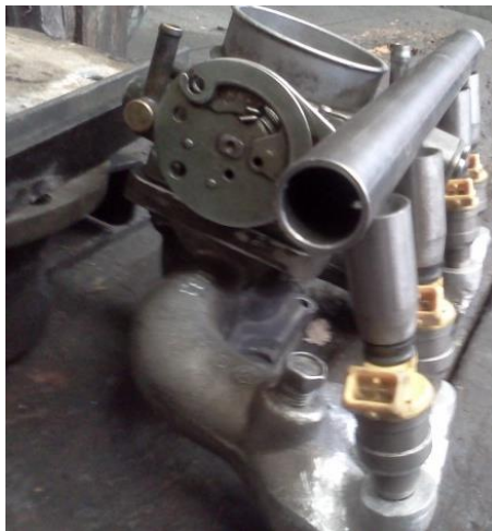
Figura 3.4 Múltiple de admisión modificado, cuerpo motorizado, riel de inyectores e inyectores Fuente: Los Autores
