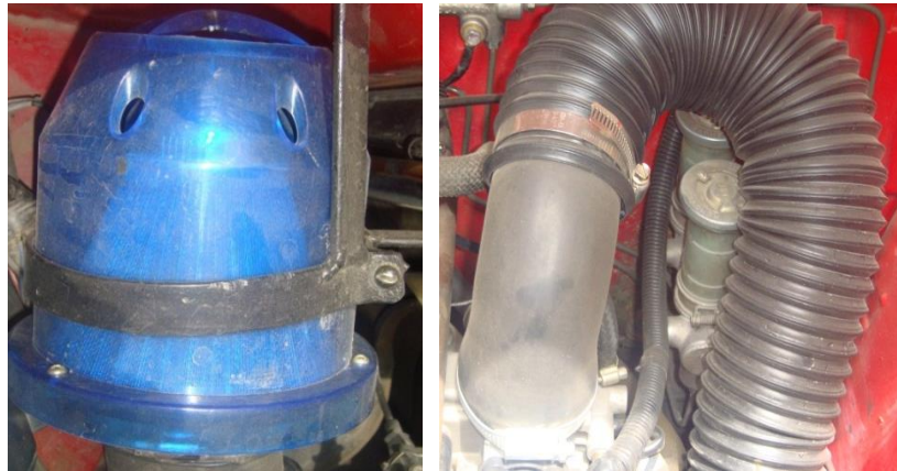
Figura 3 2 Acople para la entrada al cuerpo motorizado y filtro Fuente: Los Autores
