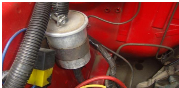
Figura 3.13 Ubicación del Filtro de Combustible Fuente: Los Autores
