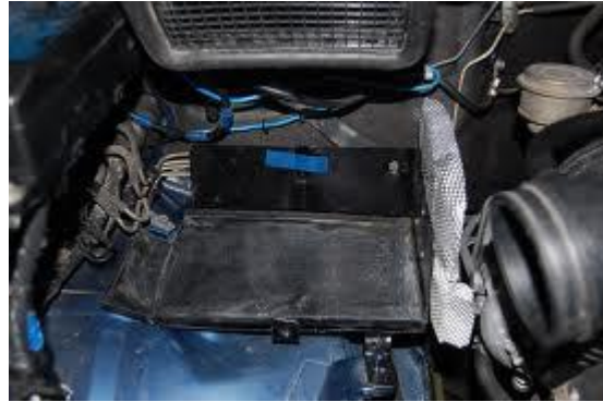
Figura 2.1 Soporte del filtro de Aire Fuente: http://www.google.com.ec/imgres/soporte filtro de aire
