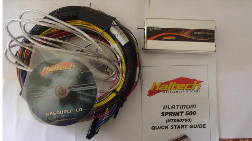
Figura 3.43 Ecu Haltech Fuente: Los Autores
