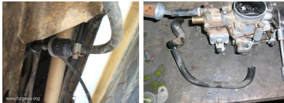
Figura 18 Tuberías de combustible
