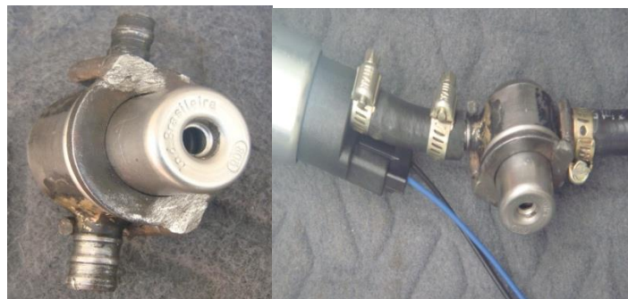
Figura 3.10 Conexión del Regulador de Presión Fuente: Los Autores
