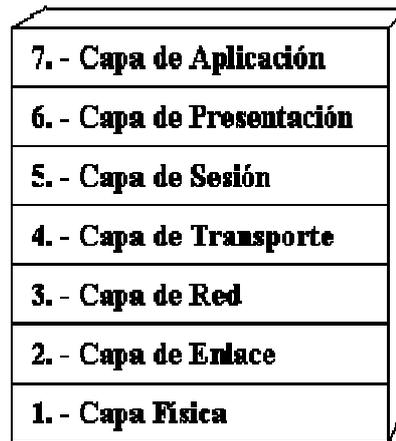
Figura 2.9: Capas del Modelo OSI
