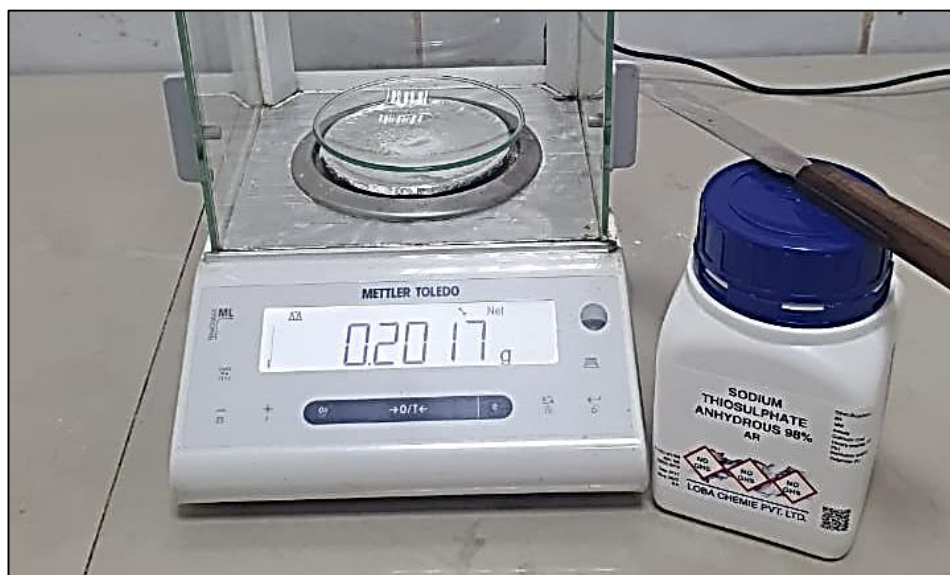
Figura 30: 0,2017gramos de Tiosulfato de sodio pesado en la balanza digital
