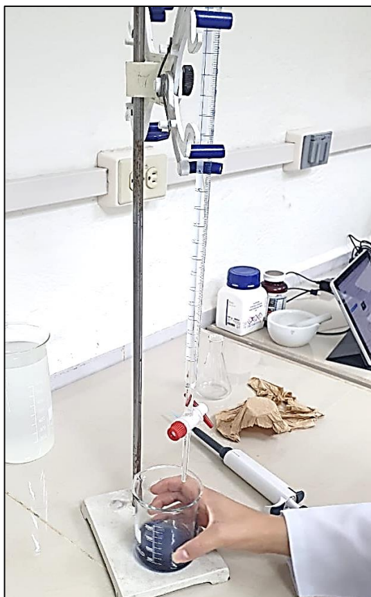
Figura 32: Reacción colorimétrica de la muestra en titulación al añadir almidón
