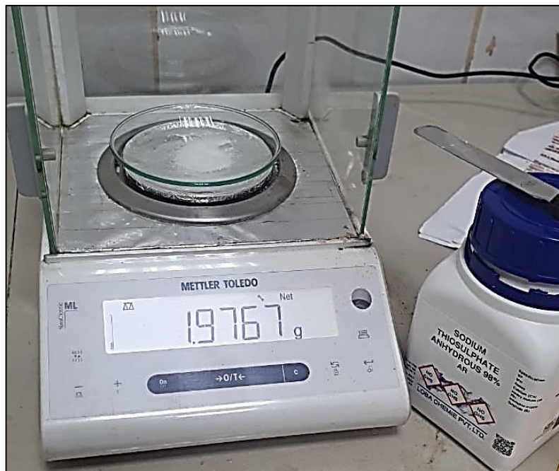
Figura 28: 1,9767 gramos Tiosulfato de sodio pesado en la balanza digital
