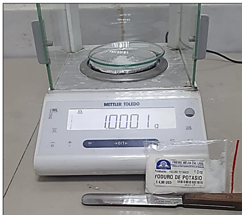
Figura 27: 1,0001 gramos de Yoduro de potasio pesado en la balanza digital
