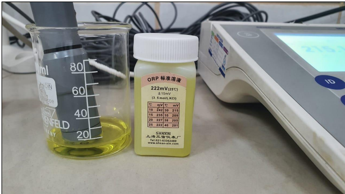
Figura 39: Lectura de la solución calibradora de ORP
