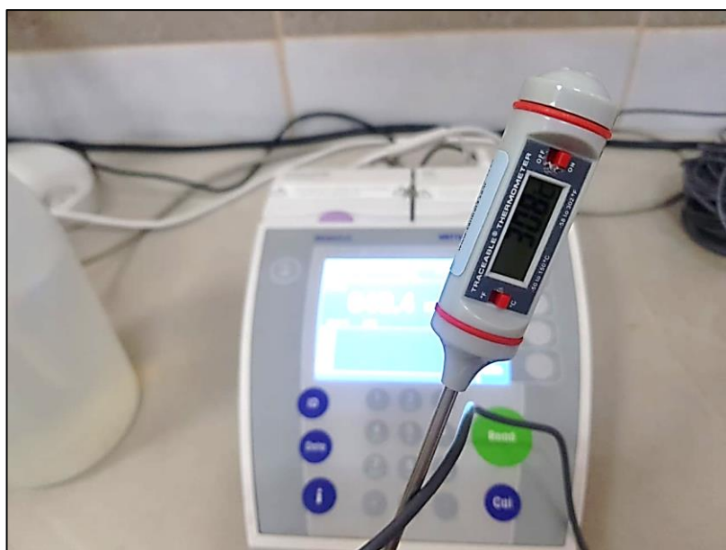
Figura 41: Termómetro digital para controlar de la temperatura de la solución
