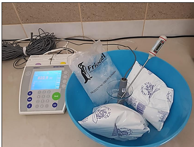
Figura 42: Bolsas de gel frio para control reducir la temperatura de la solución
