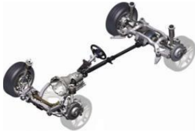
Fig.3 Motor delantero y tracción posterior. Fuente (Águeda, Gonzalo; et al. 2020)
