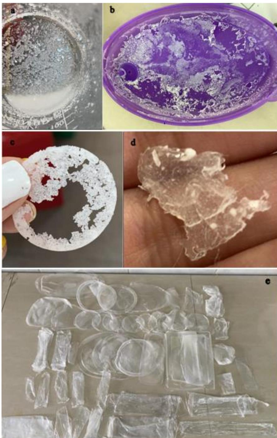
**Ilustración 40** Polímero con diferentes solventes: a) polímero con etanol, b) polímero con acetona, c) polímero con acetato de butilo, d) polímero sin disolvente, e) polímero con cloroformo.
