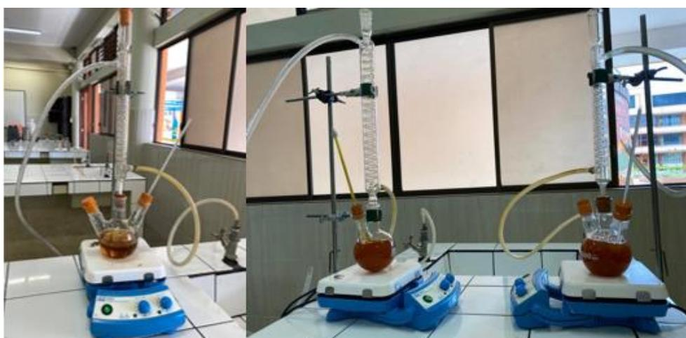
**Ilustración 13** Proceso de transesterificación del aceite.
