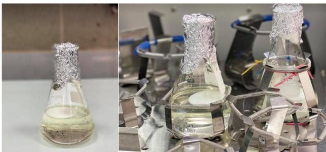
**Ilustración 30** Digestión de la biomasa húmeda y seca con cloroformo e hipoclorito de sodio.
