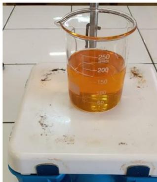
**Ilustración 10** Proceso para obtener el porcentaje de Humedad.
