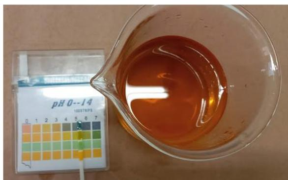
**Ilustración 4** Medición con tiras de pH.
