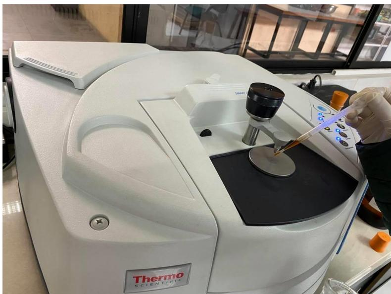
**Ilustración 15** Análisis IR de la muestra.
