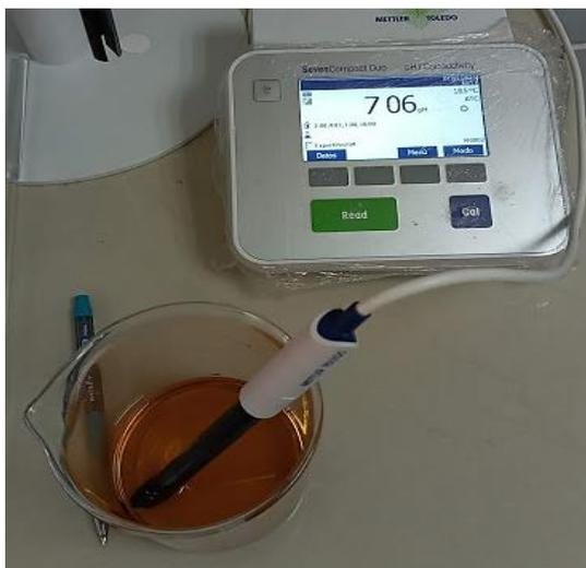
**Ilustración 17** Proceso de neutralización del glicerol.
