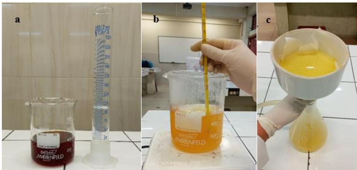
**Ilustración 19** Proceso de decoloración del glicerol, a) glicerol antes de decolorar, b) glicerol en proceso de decoloración, c) glicerol decolorado.
