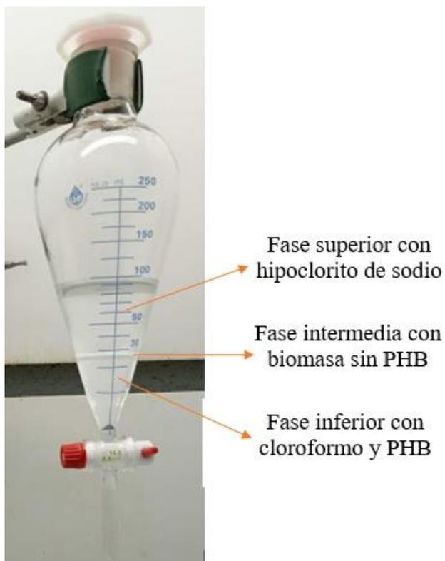
**Ilustración 31** Separación de las tres fases mediante el método de decantación.
