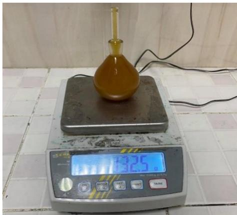
**Ilustración 5** Medición de la densidad del aceite.
