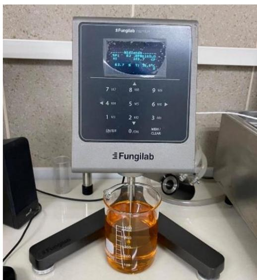
**Ilustración 6** Viscosímetro rotacional.
