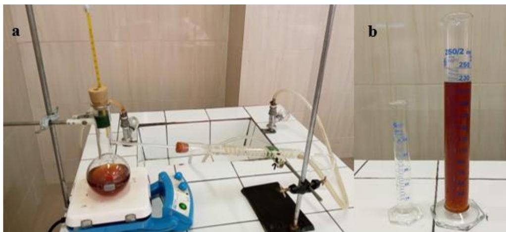
**Ilustración 18** Proceso de destilación, a) equipo de destilación simple, b) productos procedentes de la destilación el glicerol y el metanol
