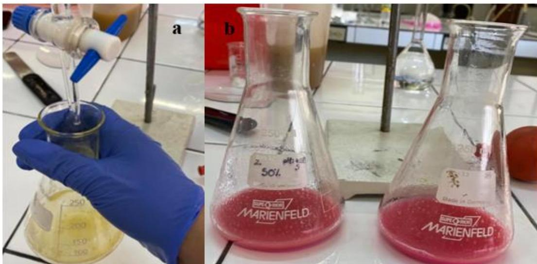
**Ilustración 9** Proceso del índice de acidez del aceite de palma usado. a) Titulación del aceite de palma usado con KOH, b) Viraje de color transparente a incoloro.
