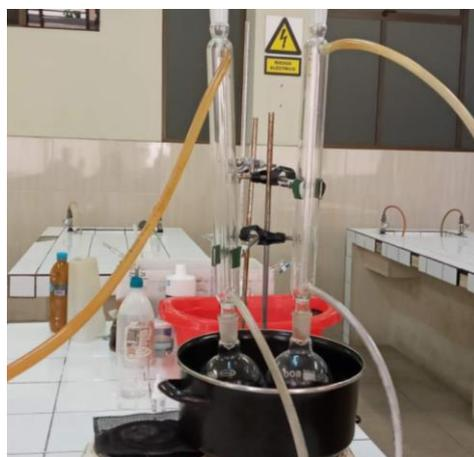
**Ilustración 7** Sistema del índice de saponificación.
