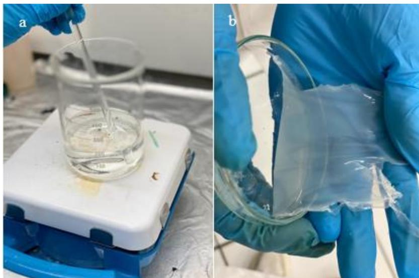
**Ilustración 34** a) Proceso de dilución del P3HB en polvo con el cloroformo, b) retiro del recipiente del biopolímero seco.
