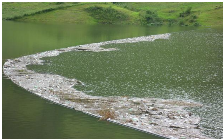
Ilustración 19: Barreras de Contención en el Embalse
