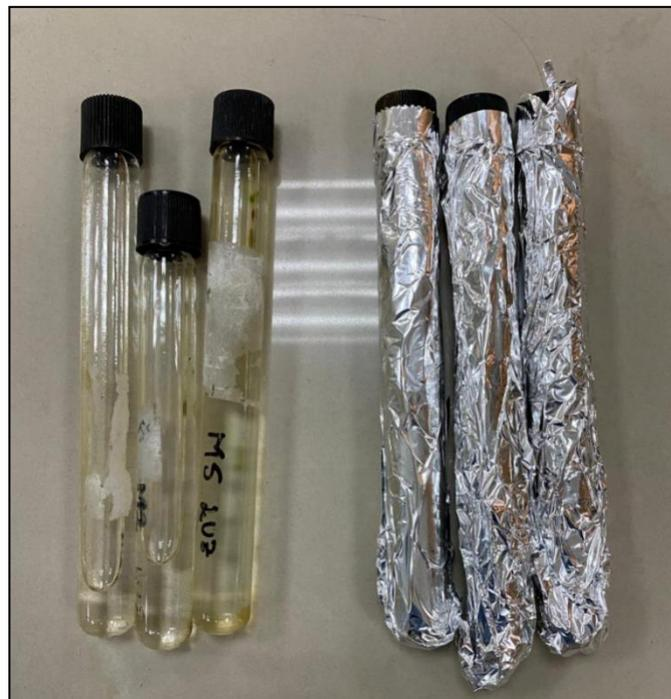
**Imagen 14.** Recubrimiento de las muestras de agua que fueron expuestas a condiciones de luz y oscuridad.
