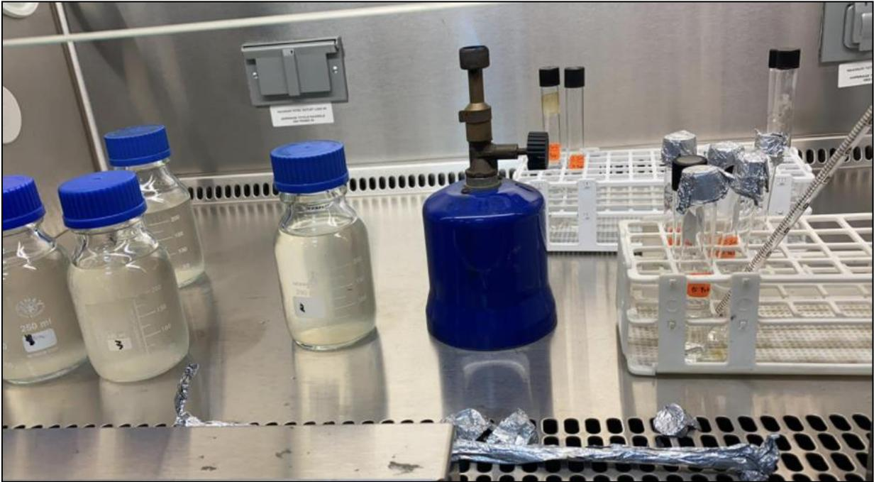
**Imagen 8.** Muestras de agua expuestas en el reactor UV, dentro de la cámara de flujo.
